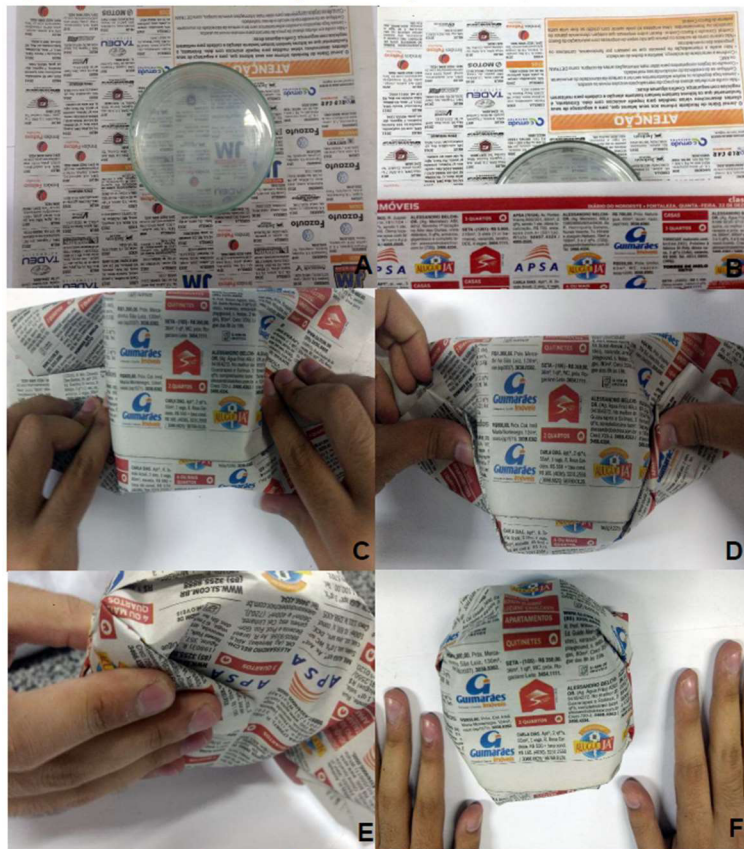
A – F: Passos a serem seguidos para o embalo de placas e Petri Fonte: o autor
