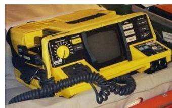
**Figura 6.5** O desfibrilador aplica descargas elétricas provenientes de um capacitor no músculo cardíaco, restabelecendo seu ritmo normal (JUNIOR; FERRARO; TOLEDO, 2009, p. 265).
