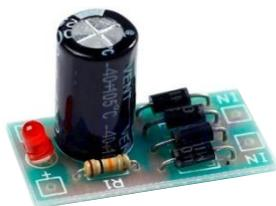
**Figura 8.4** Módulo ponte retificadora de onda completa AC/DC.
