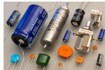
**Figura 6.8** Capacitores de vários tipos e formatos
