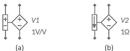
**Figura 3.11** Símbolos de circuito para (a) uma fonte ideal de tensão com controle de tensão e (b) uma fonte ideal de tensão com controle de corrente.
