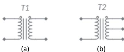
**Figura 7.7** Símbolo para transformador (a) comum e (b) com derivação central
