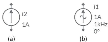
**Figura 4.4** Símbolos para fontes de corrente independente: (a) utilizada para corrente constante (CC); (b) usada para corrente variável com o tempo (AC).
