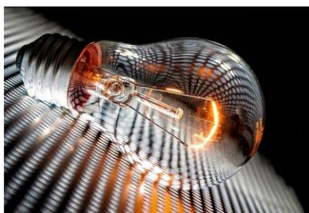
**Figura 5.1** Durante seu funcionamento as lâmpadas incandescentes convertem energia elétrica em luz e calor. Este último ocorre por efeito Joule e consiste num processo indesejado visto que provoca desperdício de energia elétrica.
