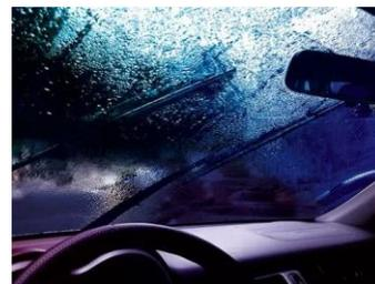
**Figura 6.4** Limpadores de para-brisa são acionados com velocidades que podem variar e até mesmo parar por um determinado intervalo de tempo. Para tanto, usam temporizadores que são ativados por meio do processo de carga e descarga de um capacitor (JUNIOR; FERRARO; TOLEDO, 2009, p. 265).
