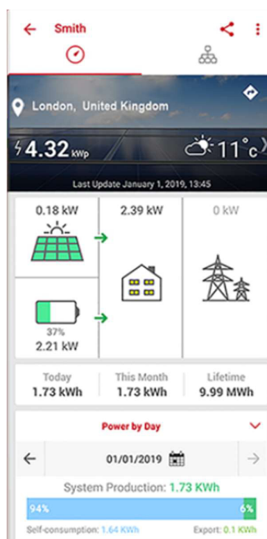
Figura 9 - Plataforma de monitoramento de sistemas com SolarEdge.
