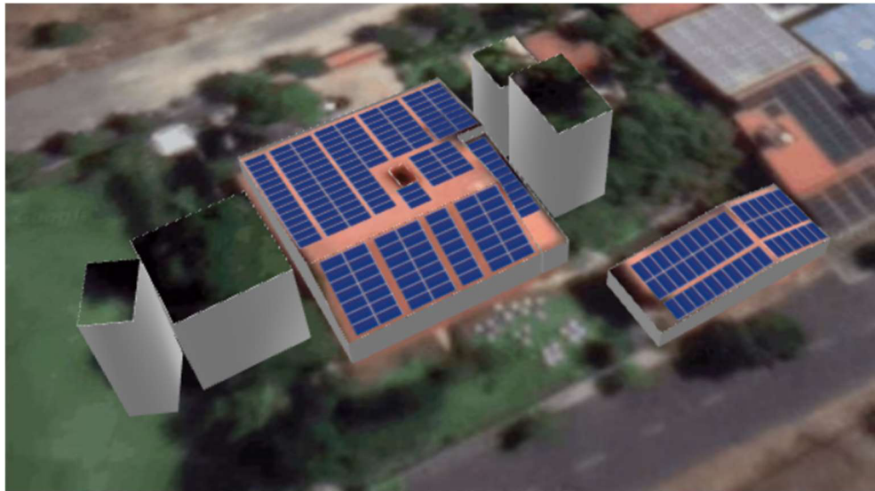
Figura 12 - Simulação de layout de instalação da Usina A através do Designer SolarEdge.
