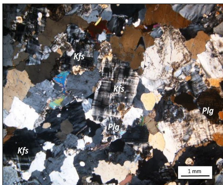
Figura 74 – Leucossoma exibindo textura ígnea heterogranular. Nícois cruzados. (Am. 46b).
