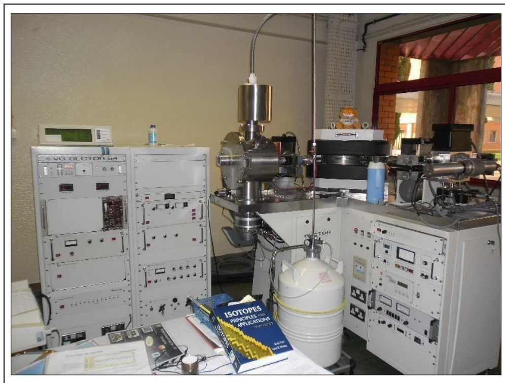
Figura 4 – Espectrômetro de Massa de Ionização Térmica (TIMS) do LGI-UA.
