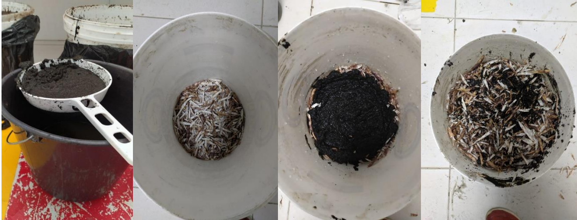
Figura 7 - Alimentação dos reatores com material estruturante e lodo bruto
