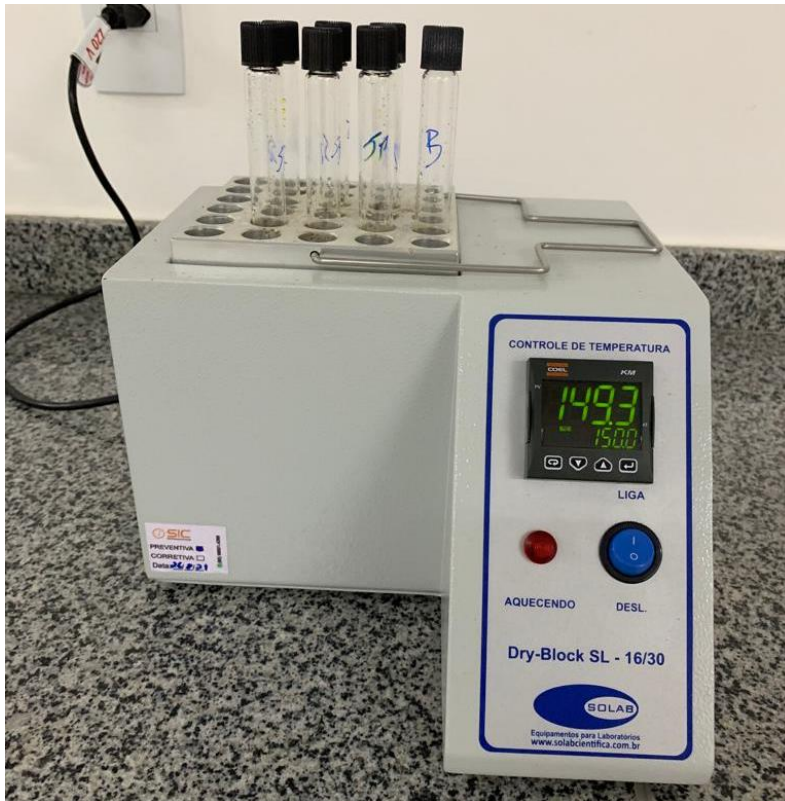
Figura 13 – Procedimento de preparação de amostras para análise de DQO
