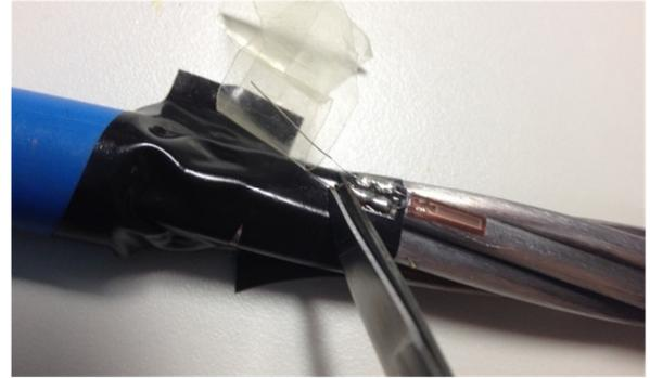
a) Soldagem dos fios do extensômetro na base para solda      b) Corte os excessos de fio
