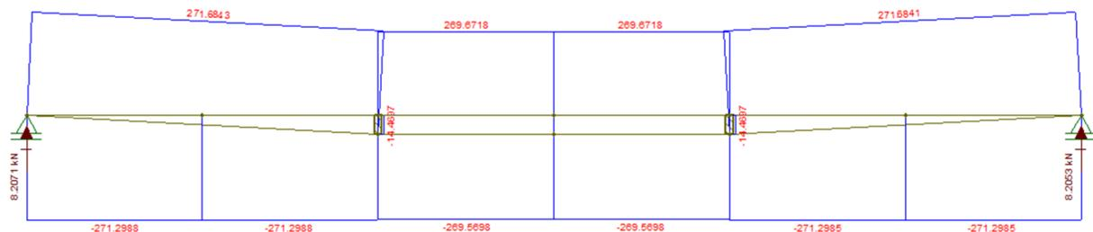
b) Diagrama de esforço normal do caso com carga de 5 kN nos terços médios
