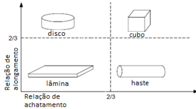
Figura 3 – Classificação da forma de agregados
