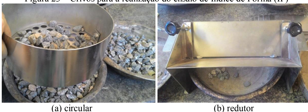
Figura 23 – Crivos para a realização do ensaio de Índice de Forma (IF)
