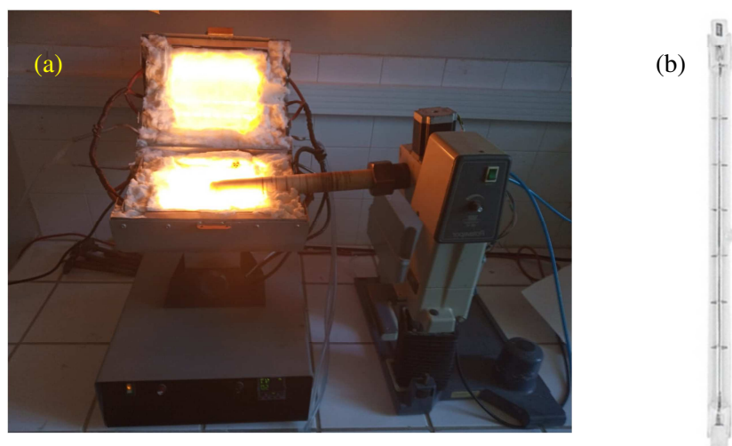
Figura 4.2 - (a) Fotografia do forno em funcionamento e com a tampa aberta e (b) lâmpada halógena
