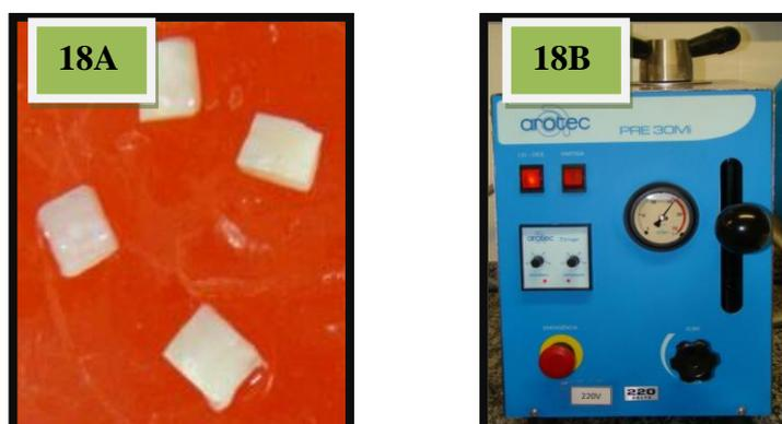
**FIGURA 18A** - Fragmentos obtidos a serem levados para a embutidora;
