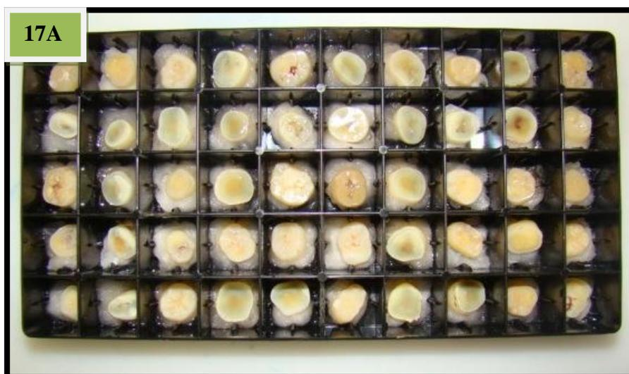
**FIGURA 17A** - Discos dentais pré - cortados embebidos em água destilada;
