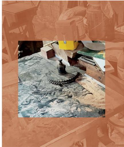
O trabalho na tupia se dá pela movimentação da peça a ser trabalhada em contato com a fresa, disco ou cilindro com lixa. O eixo central gira o pino em sua própria posição, por isso, é o marceneiro que controla todo o movimento e processo. Isso pode ser feito a partir de qualquer lugar da superfície da bancada, pois o eixo está posicionado bem no centro dela, com os elementos de desbaste acima do nível de sua área.
