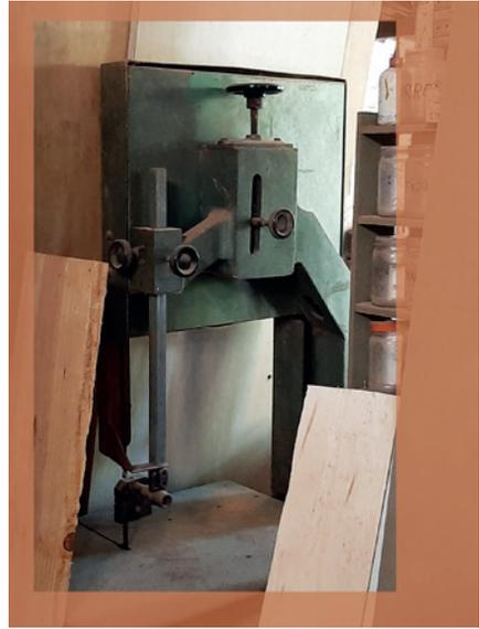
Essa fita é preenchida de dentes em uma de suas bordas, e sua espessura é bastante fina, menor do que a da lâmina da maioria dos serrotes, por exemplo. Por ter essa espessura reduzida e grande comprimento, ela se mantém direcionada e estável devido à presença de um elemento de apoio que a guia, mas não são raros os casos em que se partem durante o processo de corte. E quando isso acontece, é necessário submeter à soldagem para se realizar uma emenda.
