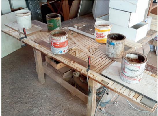
Com o gabarito elaborado previamente, ele vai contornando a placa de compensado ao redor do mesmo, com a face contendo as tariscas voltada para fora, fixando o elemento no molde com o uso de uma parafusadeira.
