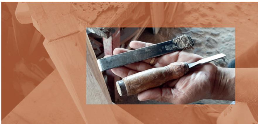
Sua estrutura é composta basicamente de duas partes: uma lâmina, de formato retangular, com chanfro destinado ao corte em uma de suas extremidades; e cabo, frequentemente feito em madeira. Além dessas duas partes, é comum haver uma base de metal na ponta do cabo, pois, como no caso dos marceneiros participantes, a utilização da ferramenta se dá em conjunto a um martelo.
