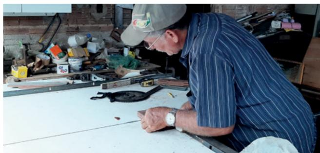
A fim de remover qualquer resquício de madeira que possa atrapalhar o encaixe correto, Sr. Luís faz uso do formão para remover os excessos. Nos locais com maior volume de material indesejado, ele aplica marteladas junto ao formão para que a ferramenta penetre nas áreas mais difíceis.
