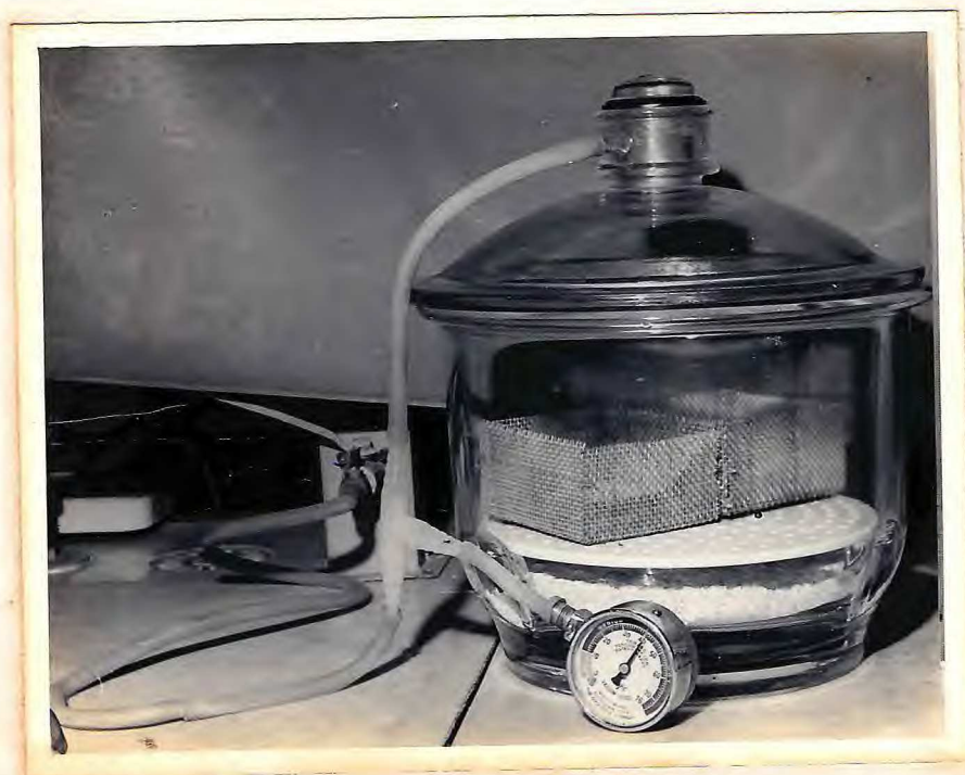
Figura 2 - Conjunto dessecador-tensiômetro-depósitos de tela de arame, utilizado no processo de desidratação.
