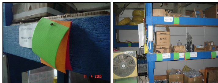
Figura 3: Detalhe dos kanbans de sinalização instalados no almoxarifado
