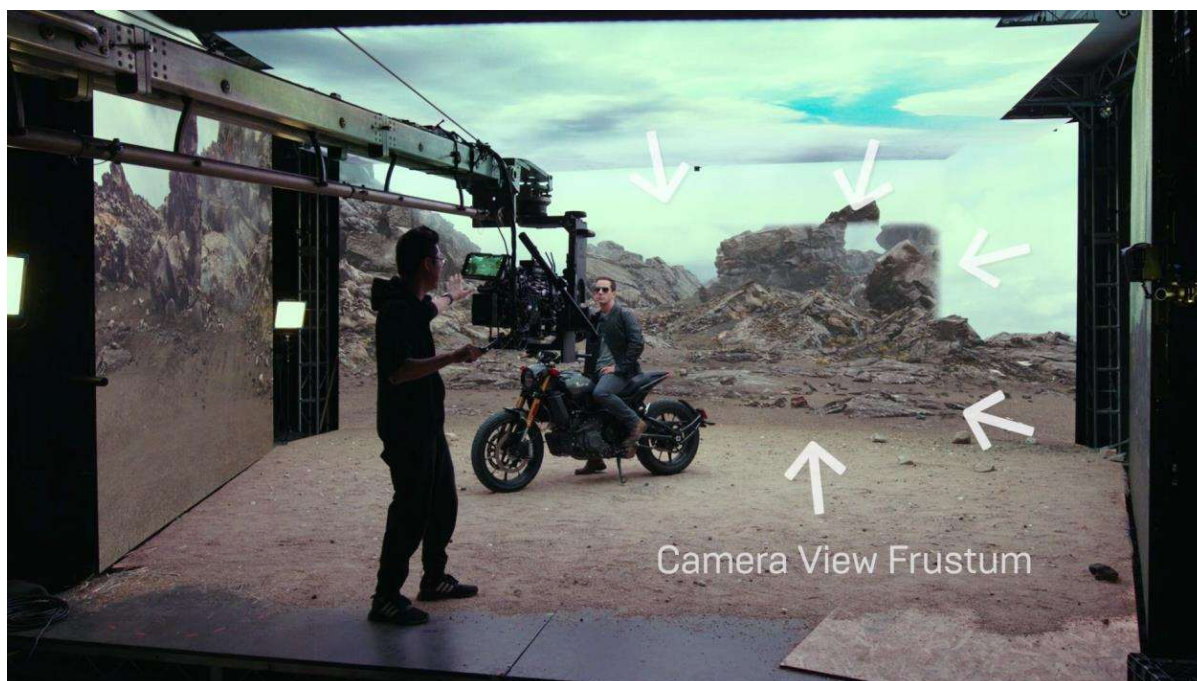
Figura 44 — Tronco interno da câmera e tronco externo
