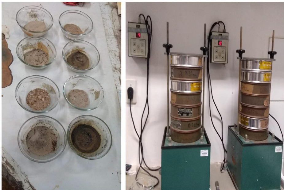
Figura 7 – Amostras de sedimento para análise granulométrica e agitador Rot Up Sieve Shaker
