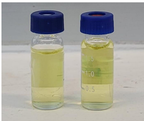
Figura 13 – Soluções armazenadas em vials de 2,0 mL para injeção no CG-MS.
