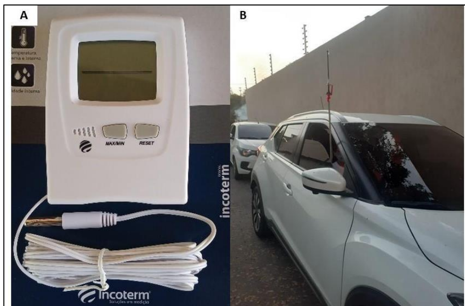
Figura 14 - Termo-higrômetro utilizado na medição (A); Veículo equipado com haste e termo-higrômetro (B)
