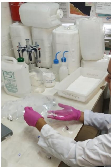
Figura 4 - Preparação dos tubos inox para a determinação da densidade
