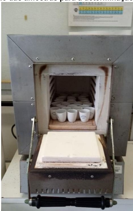
Figura 5 – Calcinação das amostras para a determinação da matéria orgânica
