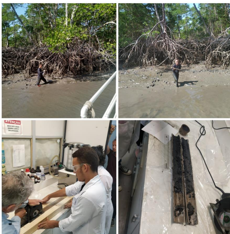
Figura 3– Coleta e abertura dos testemunhos sedimentares
