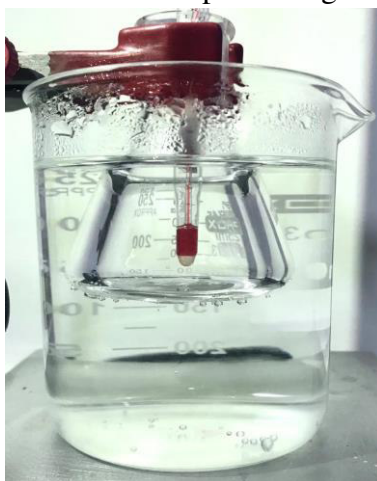
Figura 14: Sistema para a determinação do ponto de fusão das formulações, baseado no método do ponto de gota.
