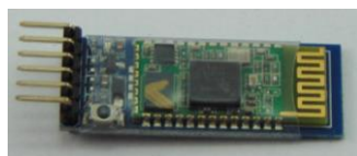
Figura 11. Módulo Bluetooth RS232 HC-05. Fonte: Elaborado pelo autor.
