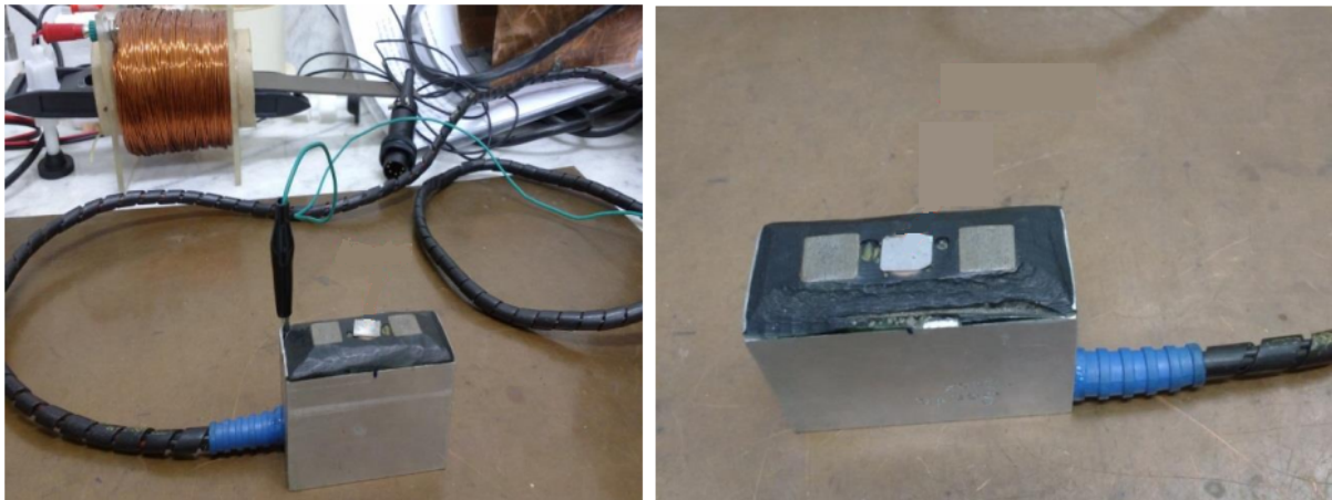
Figura 35 – Sonda do equipamento de bancada para propriedades de histerese magnética
