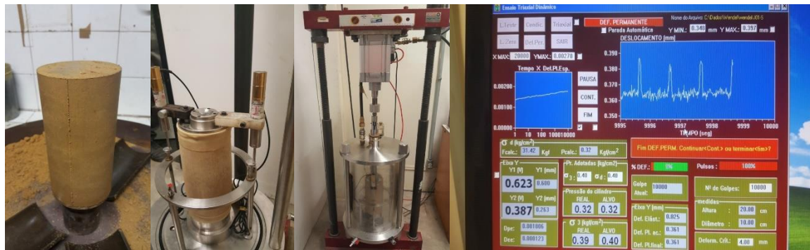
Figura 2: Etapas do ensaio de deformação permanente.
