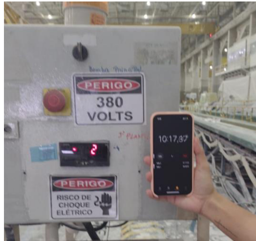
Figura 25 - Teste de vácuo das amostras (2mbar em 10 min)
