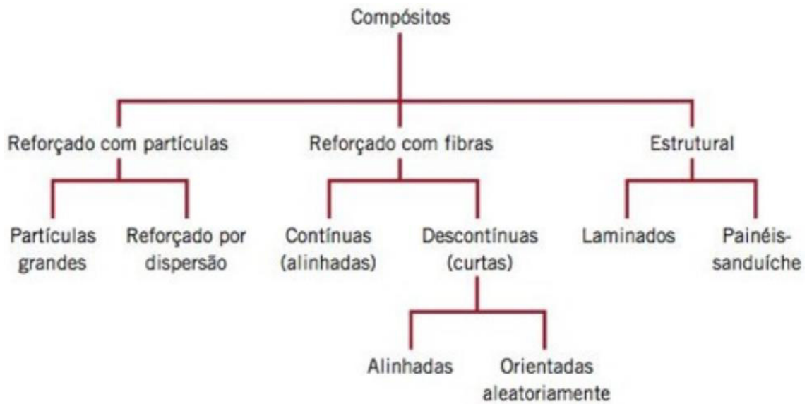
Figura 4 - Esquema de classificação para os vários tipos de compósitos.
