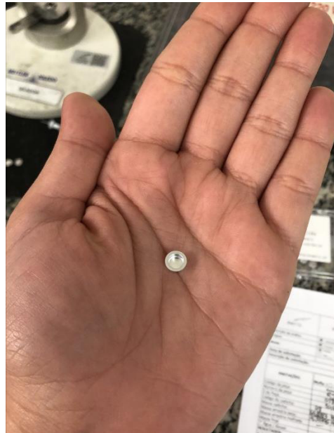
Figura 34 - Dimensional do cadinho utilizado para o teste de Tg
