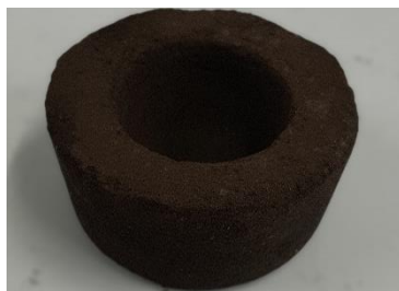
Figura 6 – Bloco teste com 25% de ligante desmoldado a quente e usinado.
