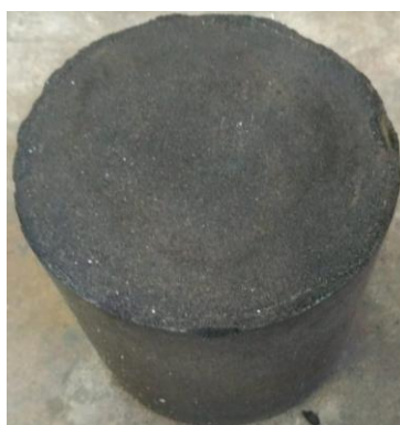
Figura 7 – Coloração do bloco verde após retirada do molde a quente.
