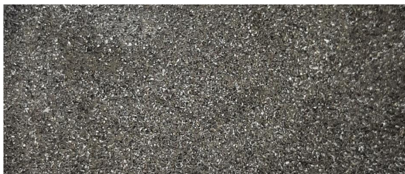
Figura 5 – Aspecto homogêneo e úmido da mistura após adição do melaço.
