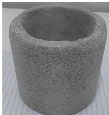
Figura 9 – Coloração do cadinho após pré-sinterização a 900°C.
