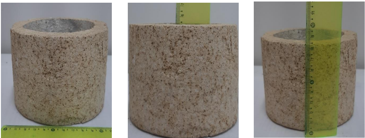
Figura 11 – Cadinho após sinterização a 1.400°C.
