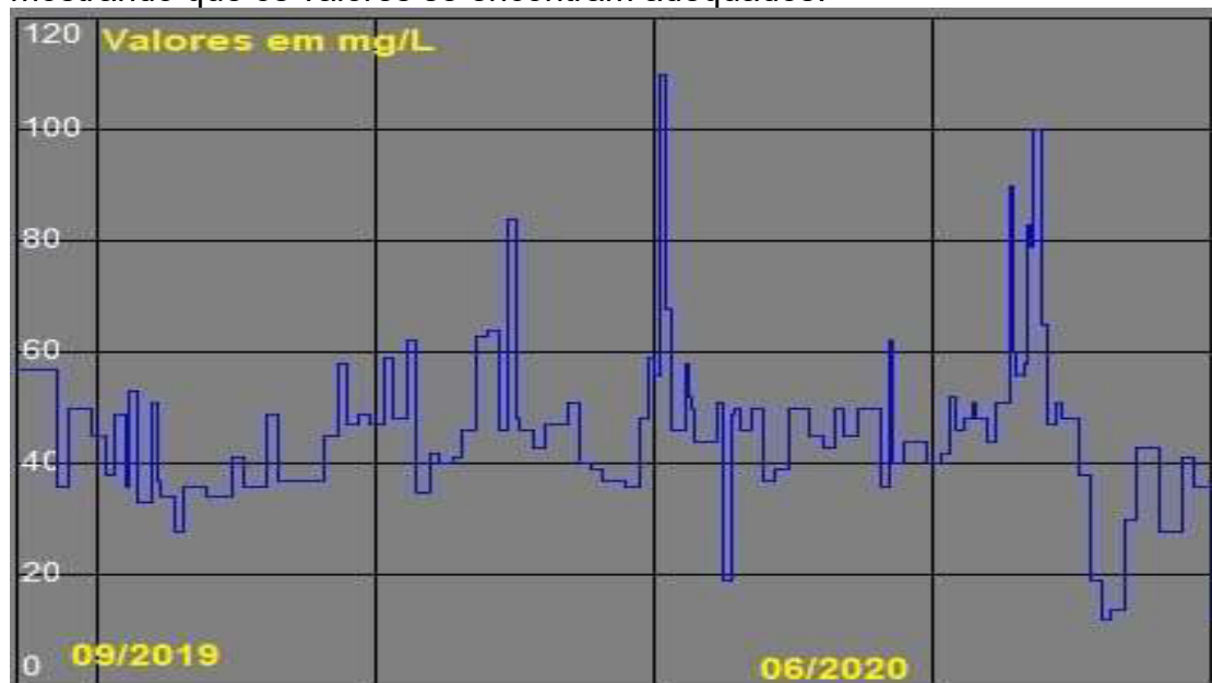
Figura 28 – Gráfico da sílica (em mg/L) da água da caldeira em estudo, mostrando que os valores se encontram adequados.
