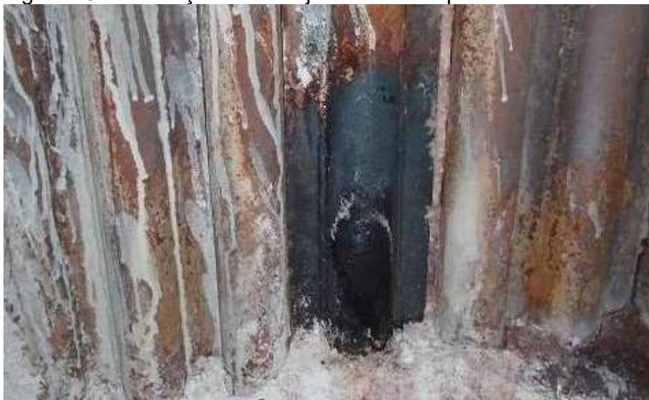
Figura 15 - Formação de laranja em tubo da parede oeste.
