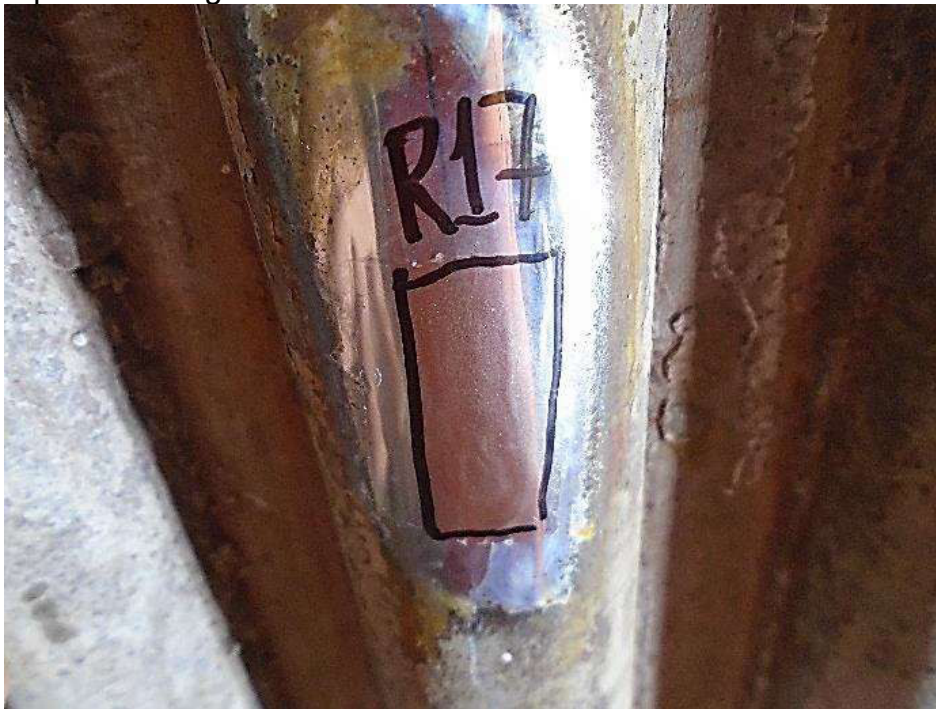
Figura 11 - Superfície de tubo polida para realização do ensaio de réplica metalográfica.
