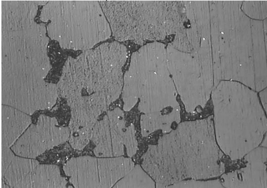
Figura 17 – Microestrutura composta por matriz ferrítica e perlita lamelar com presença de esferoidização. Dureza média: 111 HB. Aumento: 800x. Tubo da parede norte, 800 mm de altura.
