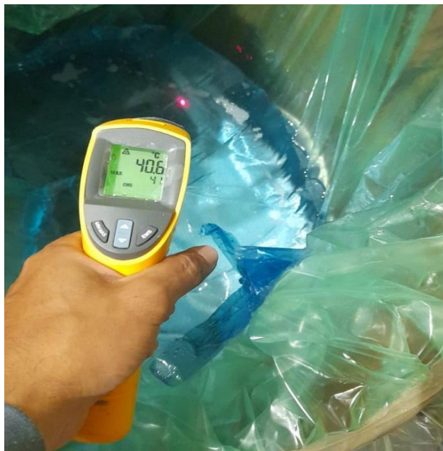
Figura 22 — Evidência de temperatura alta
