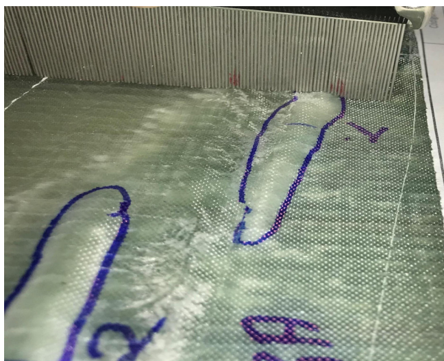
Figura 12 — Medição de ruga utilizando pente de ruga
