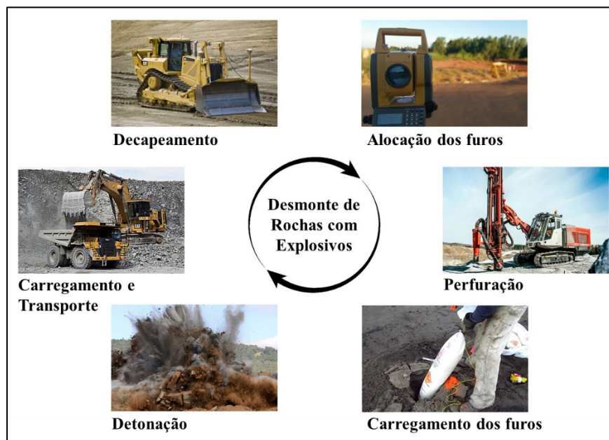
Figura 1 – Ciclo de etapas do desmonte de rochas com uso de explosivos.
