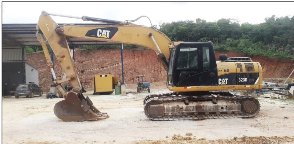
Figura 24 – Escavadeira hidráulica Caterpillar 323D.
