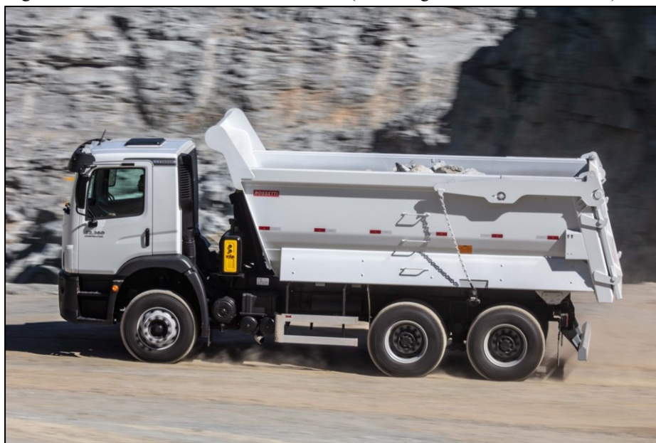
Figura 13 – Caminhão basculante rodoviário (Volkswagen Constellation 32.360).
