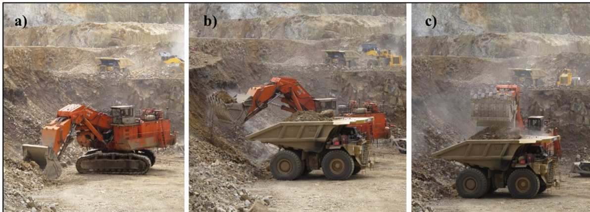
Figura 3 – Operação de carregamento: a) escavação; b) elevação; c) despejo.
