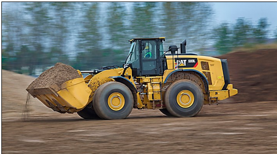
Figura 10 – Carregadeira de rodas (Caterpillar 980L).
