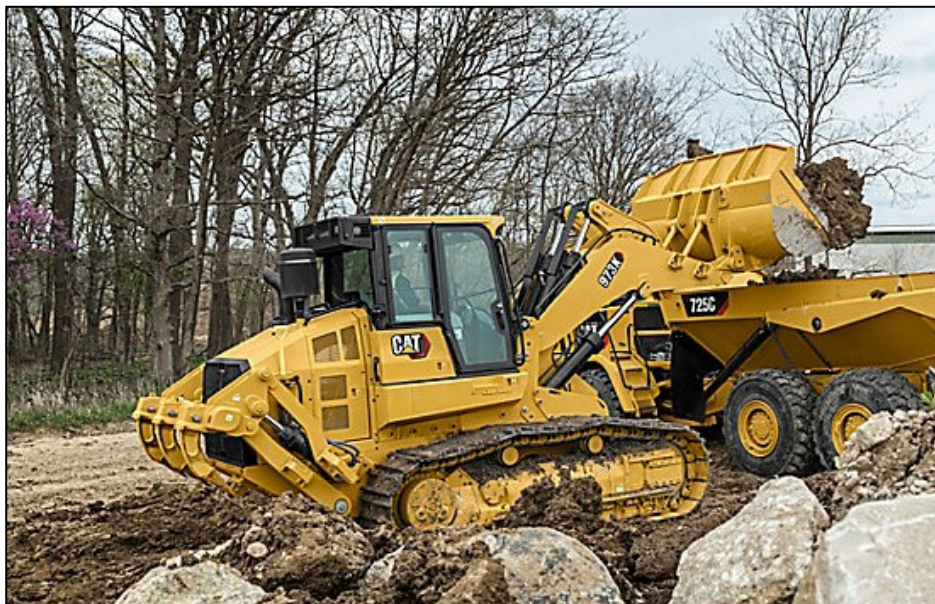
Figura 11 – Carregadeira de esteiras (Caterpillar 973K).
