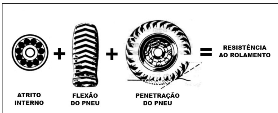
Figura 16 – Fatores que geram a resistência ao rolamento.
