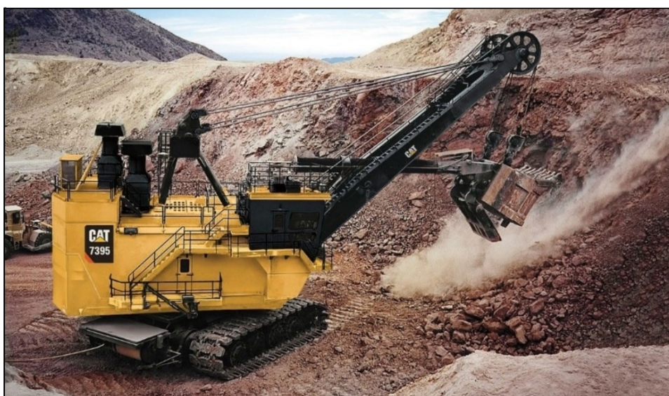
Figura 6 – Shovel a cabo (Caterpillar 7395).
