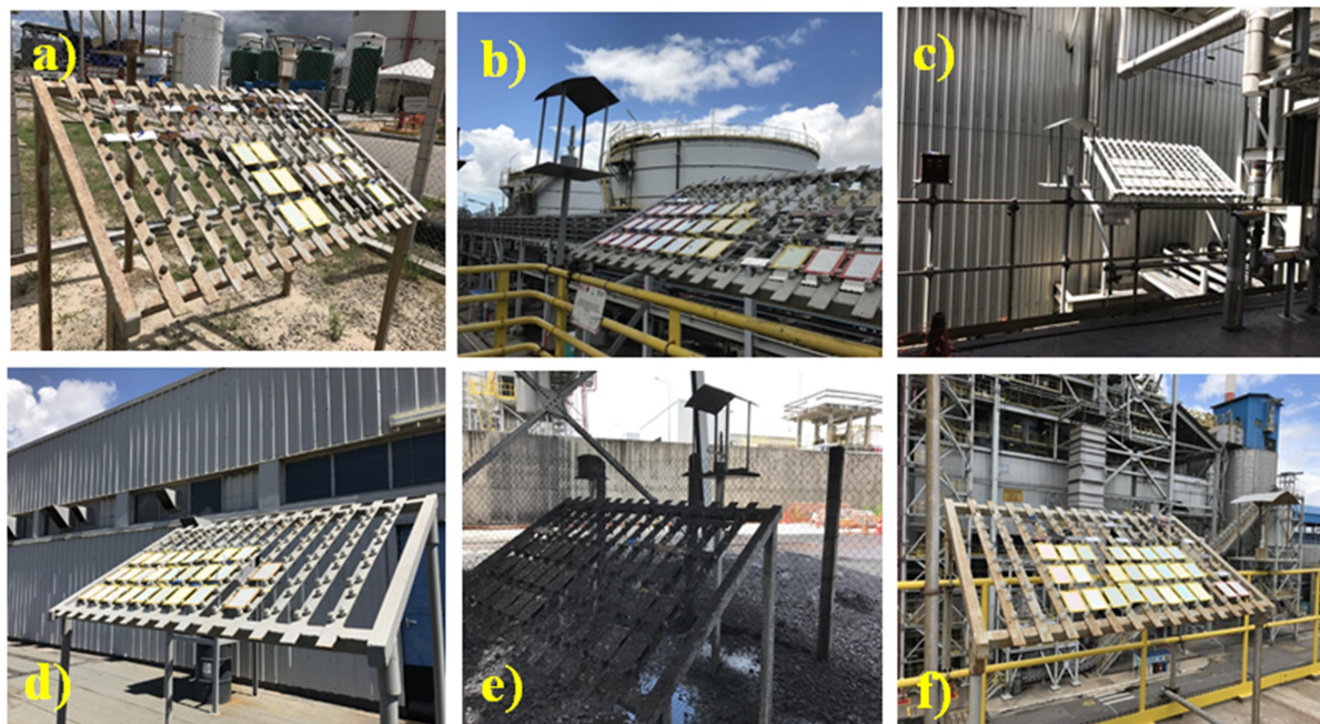
Figura 7 - Estações de Corrosão (EC) atmosférica na usina Termelétrica: a) EC 1- Entre torres de resfriamento 1 e 2, b) EC 2 - Escada próximo a caldeira 1, c) EC 3 – Próximo a Turbina, d) EC 4 Prédio ADM, e) EC 5 - Esteira de Carvão, f) EC 6 - Torre de resfriamento 3
