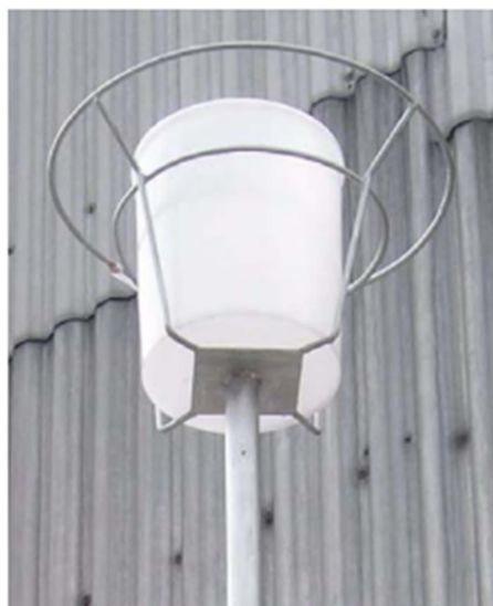
Figura 10 - Vela coletora de cloretos e suporte da vela
