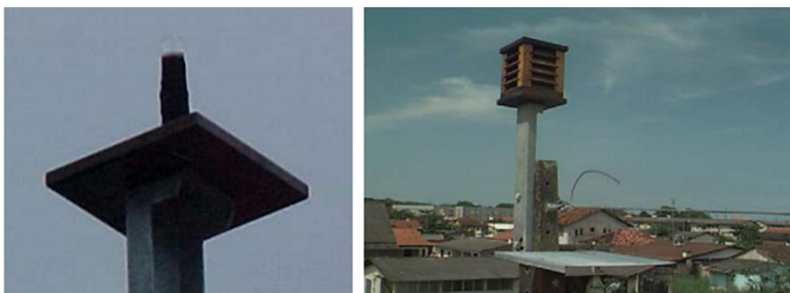
Figura 9 - Vela coletora de cloretos e suporte da vela
