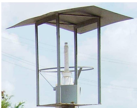
Figura 8 - vela coletora de cloretos e suporte da vela
