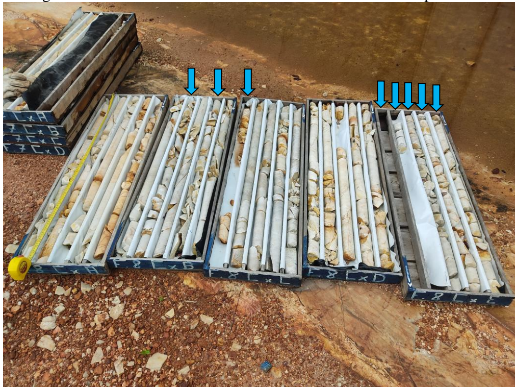
Figura 06 – Modelo de testemunhos com intervalos não recuperados
