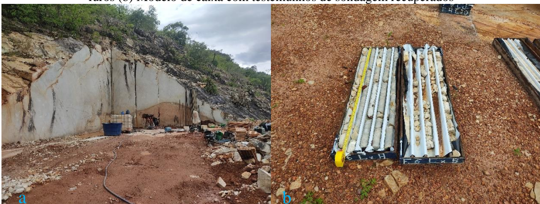
Figura 03 – Maquinário de sondagem e testemunhos gerados – (a) Aplicação da máquina Mach 920 em um dos furos (b) Modelo de caixa com testemunhos de sondagem recuperados
