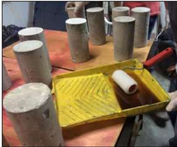
Figura 10 – Aplicação do primer
