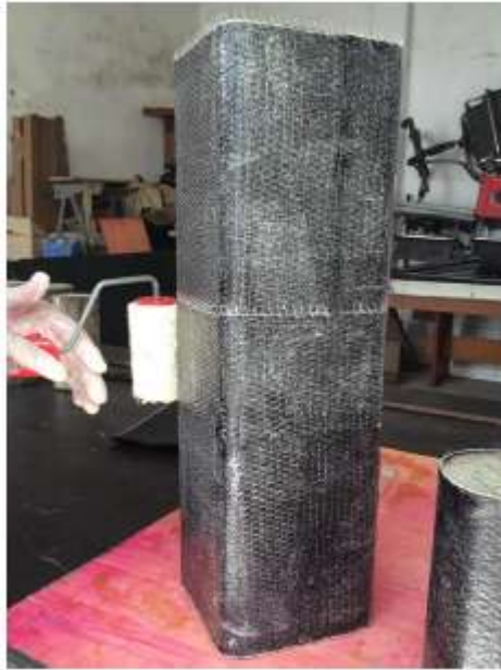
Figura 15 – Aplicação da camada de resina saturante sobre a camada de fibra de carbono em um corpo de prova prismático
