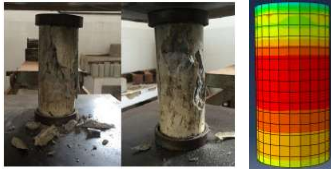
Figura 50 – Modo de falha do espécime circular sem reforço
