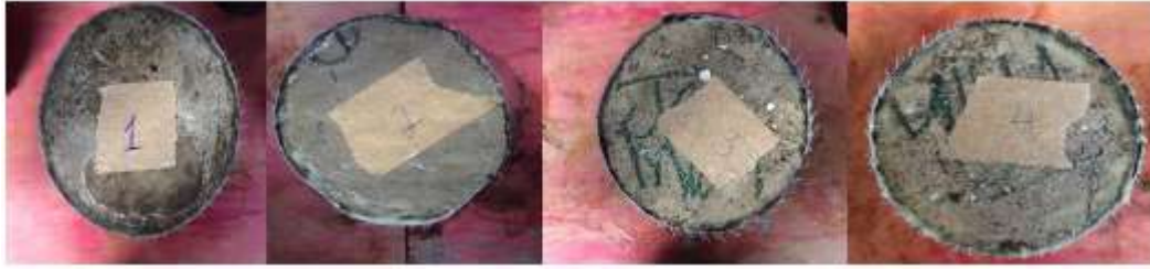
Figura 16 – Seções transversais de corpos de prova com variadas quantidades de camadas de tecido de fibra de carbono
