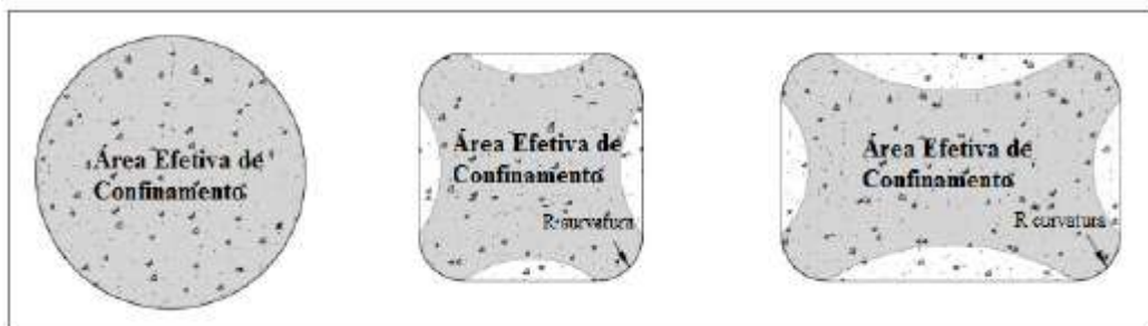
Figura 26 – Área de confinamento efetivo em colunas circulares, quadradas e retangulares
