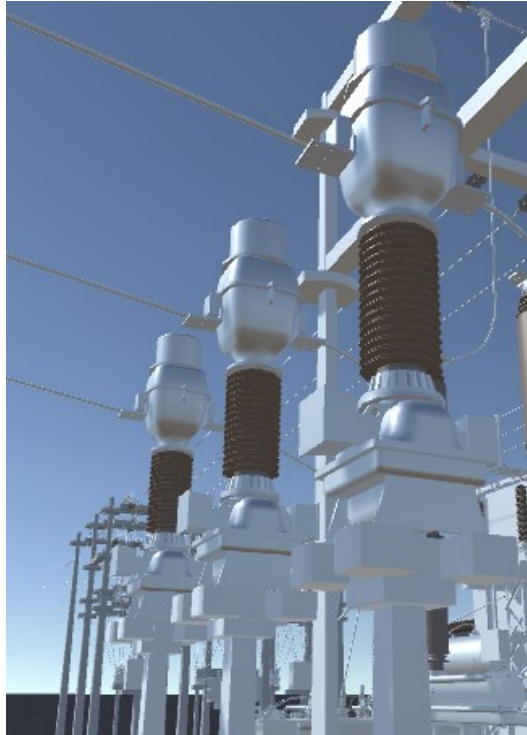
Figura 8 – Transformador de corrente virtual.
