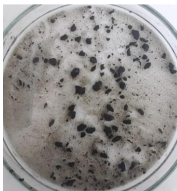
Figura 10 – Grânulos maduros obtidos do reator LGA operado em escala piloto.
