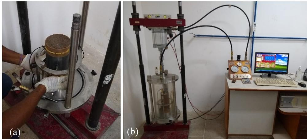
(a) Montagem do corpo de prova para MR; (b) Equipamento triaxial dinâmico. Fonte: Autora (2022).
