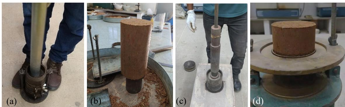
(a) Moldagem de corpo de prova no cilindro tripartido para MR. (b) Corpo de prova de 100mm por 200mm desmoldado para MR. (c) Moldagem de corpo de prova *Marshall* para ensaio de RTCD. (d) Corpo de prova *Marshall* desmoldado para ensaio de RTCD. Fonte: Autora (2022).
