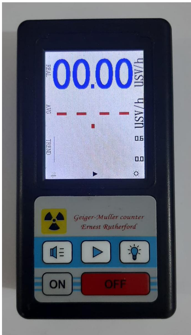
Figura 24- Contador Geiger-Muller Ernest-Rutherford BR-6 utilizado para medidas da radiação em campo.
