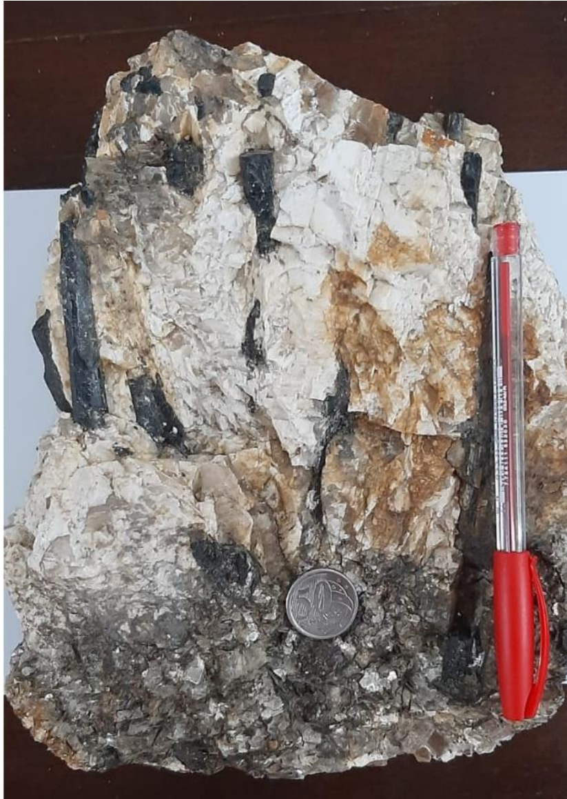
Figura 13- Rocha pegmatítica contendo cristais de quartzo, feldspato, granada, mica e schorlita.
