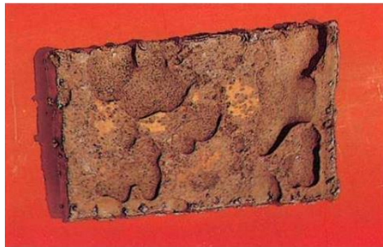
Figura 2 - Corrosão por placas
