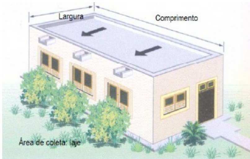
Figura 2 – Área de captação em lajes
