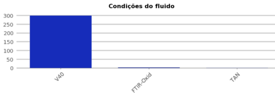
Figura 31-Gráf. condições do fluido lubrificante do redutor raspador masseira 05
