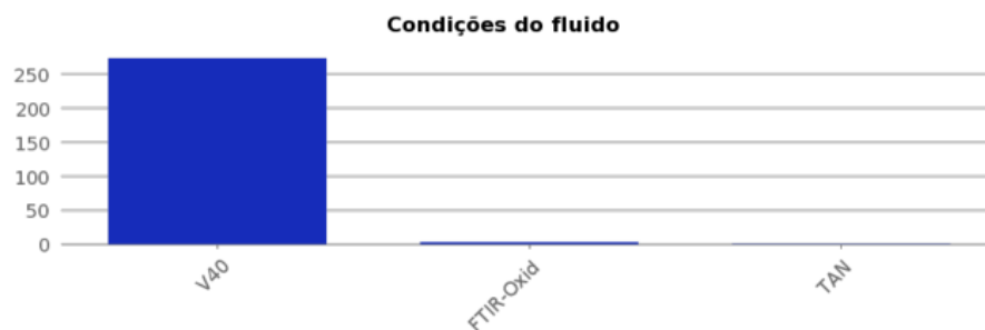
Figura 41-Gráf. condições do fluido lubrificante do redutor raspador masseira 06
