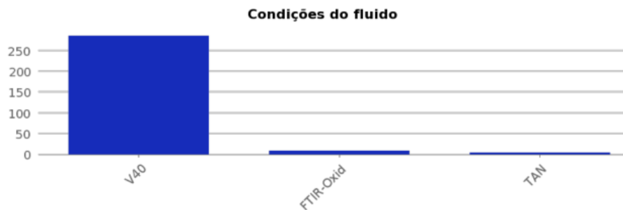
Figura 36-Gráf. condições do fluido lubrificante do redutor tanque homogeneização 15 sintético
