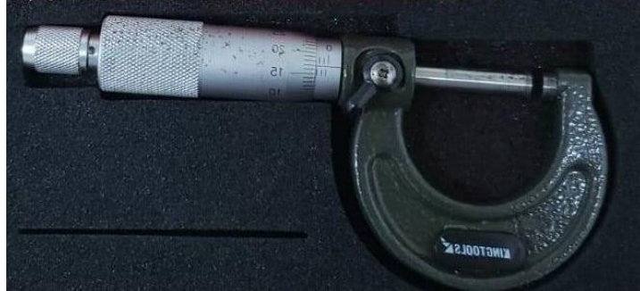
Figura 20 – Micrometro analógico Kingtools 0-25x0,01mm
