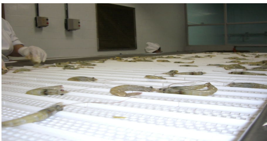
Figura 3 – Esteira de seleção manual usada na CINA, em Fortaleza – Ceará
