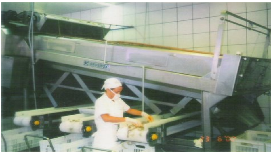
Figura 5 – Máquina classificadora de camarões utilizada na CINA, em Fortaleza – Ceará
