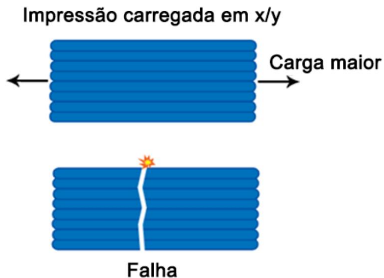
Figura 31 - Fratura do CP perpendicular a aplicação da força
