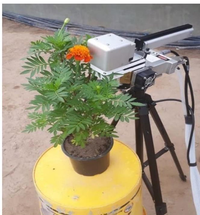
Figura 27: Medições de trocas gasosas utilizando o analisador de gases infravermelho portátil (IRGA), mod. Li - 6400XT, Licor, USA
