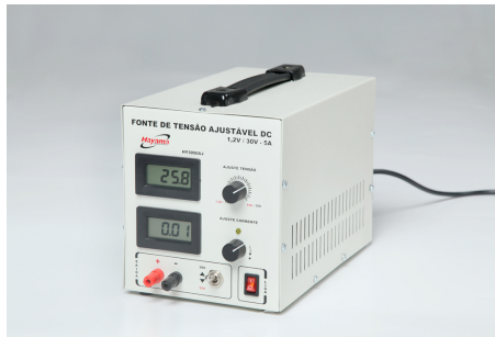
Figura 32 – Fonte regulável utilizada para calibração do sensor de tensão e corrente
