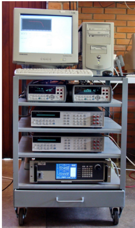
Figura 22 – Traçador de curva I x V produzido com fonte de 4 quadrantes
