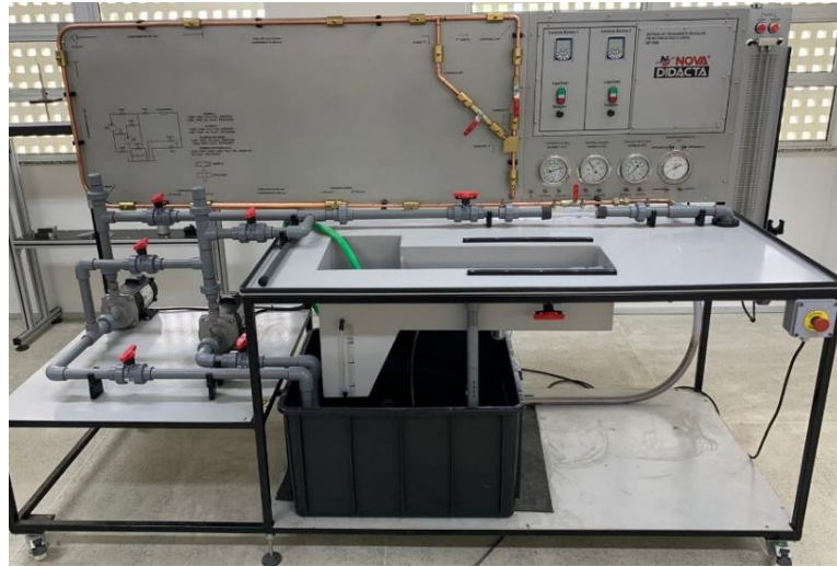
Figura 1 - Bancada de mecânica dos fluídos localizada no laboratório de ciências térmicas e fluidos da UFC - campus Russas.
