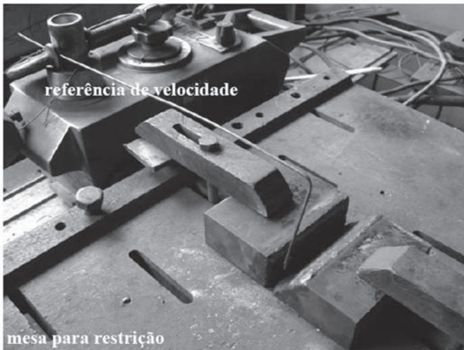
Figura 2. Mesa para restrição das juntas meio-v e sistema de referência de velocidade.
