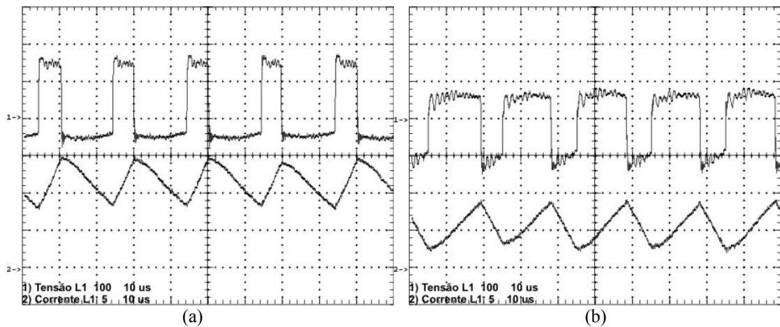
Fig. 4.18 – Formas de onda da tensão e corrente no indutor L1 na frequência de comutação: (a) modo de não-sobreposição (100V/div, 5A/div); (b) modo de sobreposição(100V/div, 5A/div). Tempo (10µs/div).
