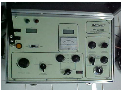
Foto 4: Equipamentos medidores de Fator de Potência, da Nansen.
