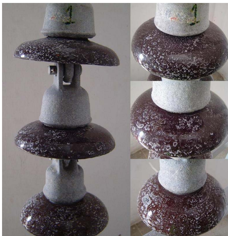
Figura 3.59 - Cadeia de isoladores poluída artificialmente antes do teste com o procedimento alternativo (foto do autor).
