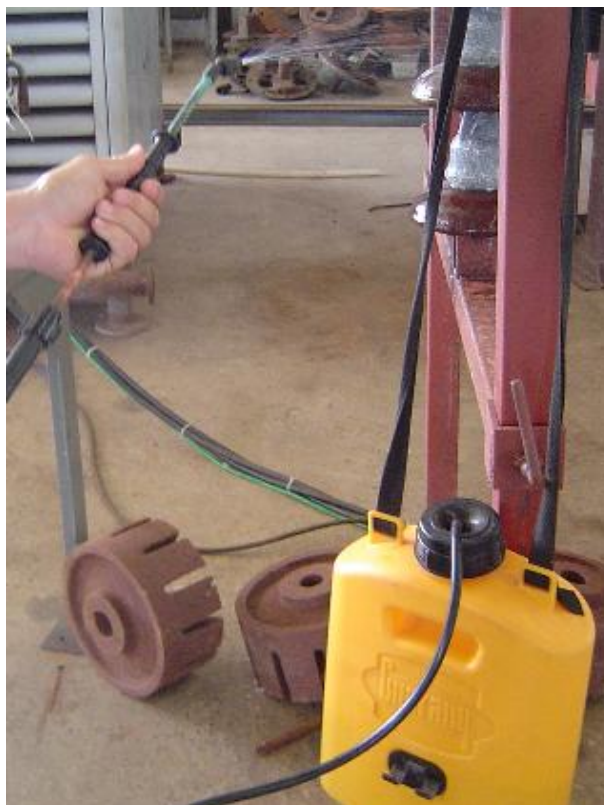
Figura 3.6 - Aplicação da solução salina nos isoladores pelo método manual (foto do autor).
