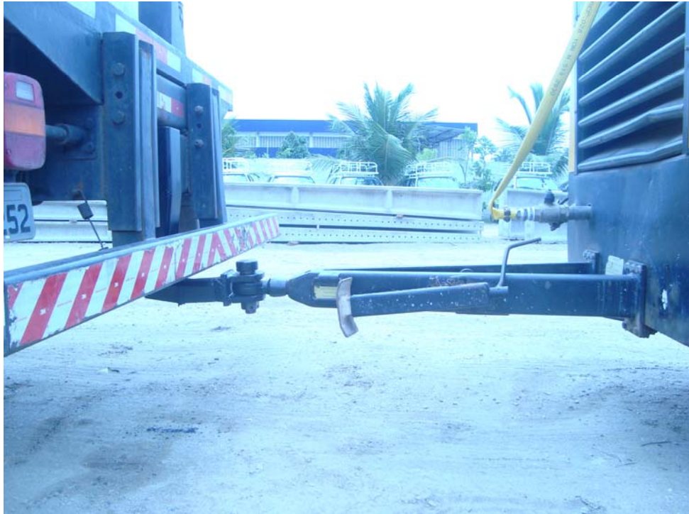
Figura 4.10 - Acoplamento entre caminhão munck e carroceria do compressor (foto do autor).
