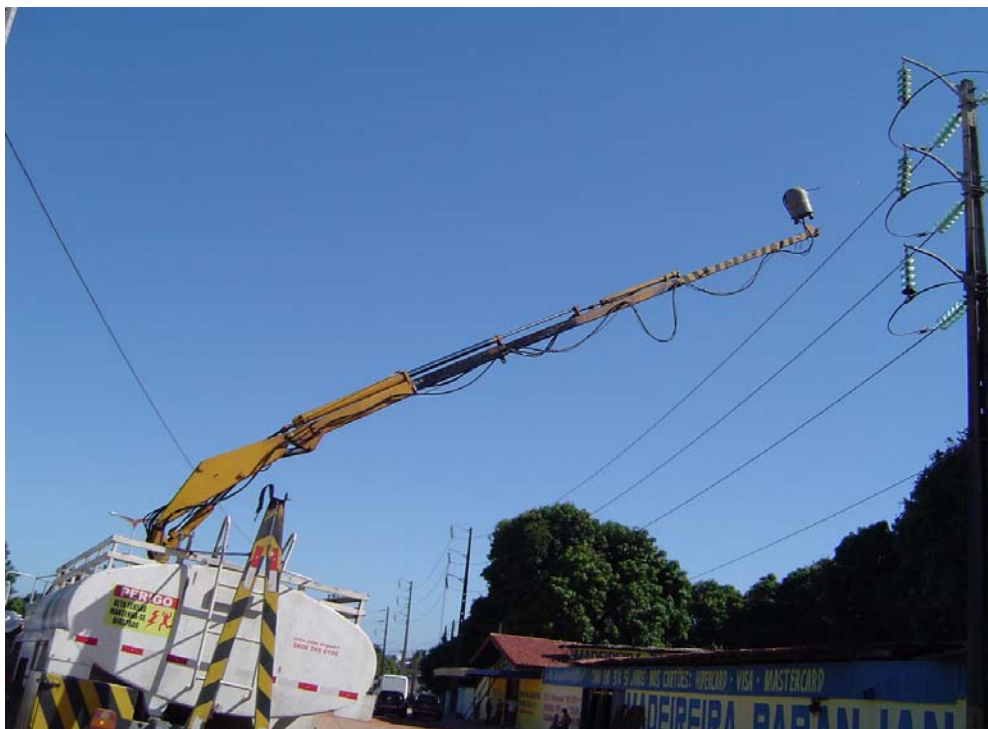
Figura 1.1 - Sistema convencional de lavagem com robô instalado em um guindauto de um caminhão munck.
