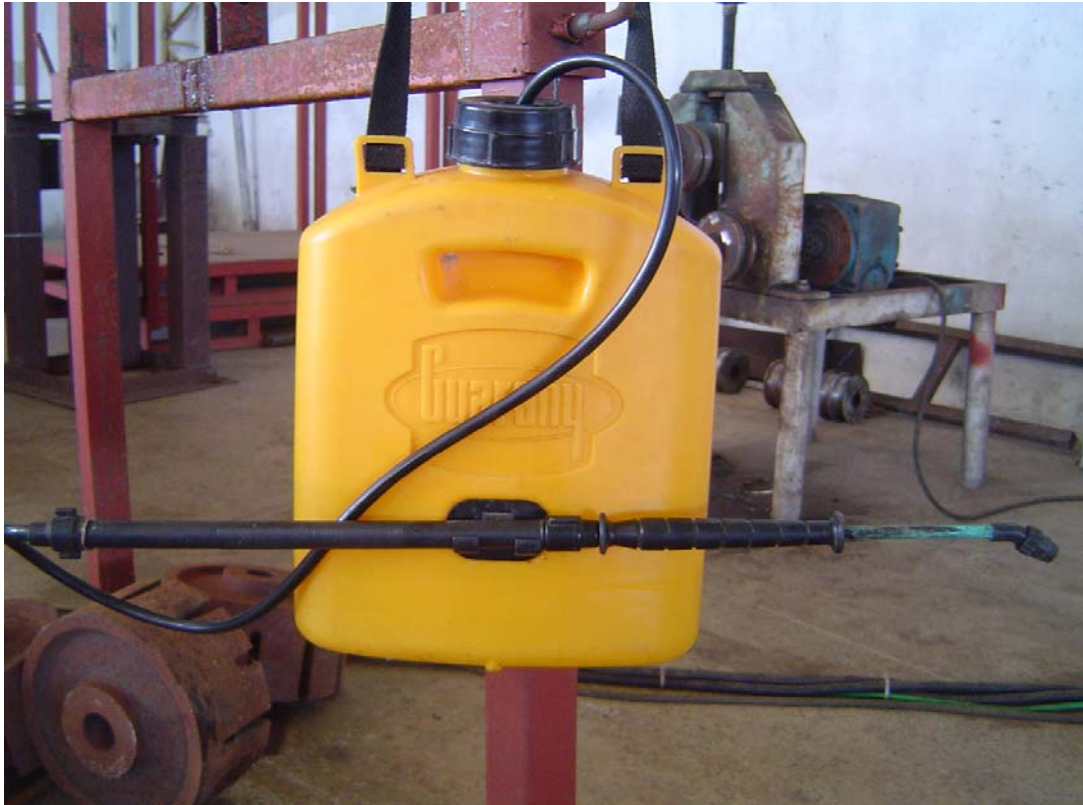
Figura 3.4 - Borrifador da solução salina pelo método manual (foto do autor).
