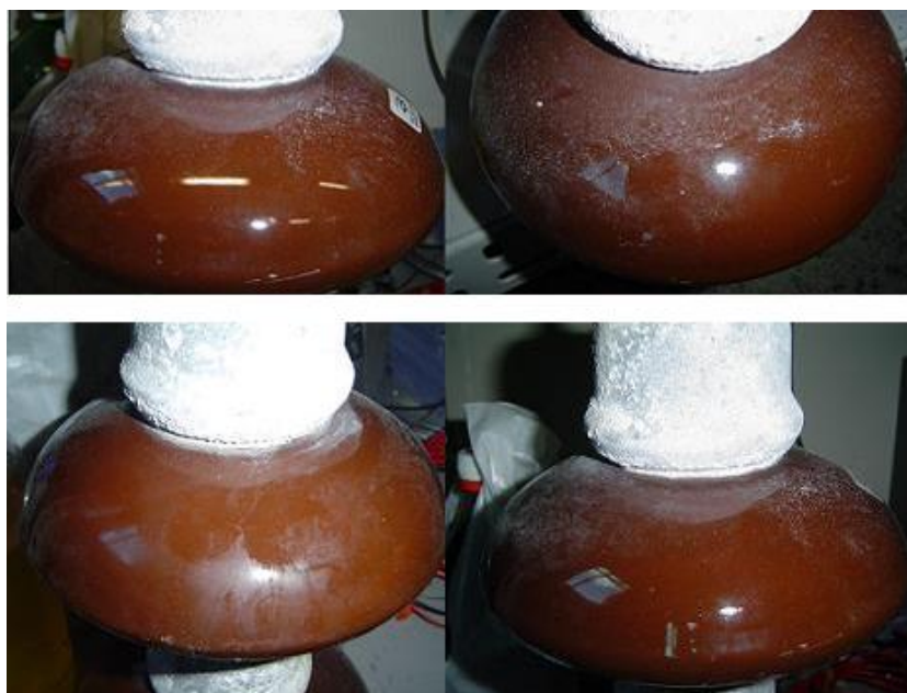
Figura 3.57 - Comparação visual de isoladores naturalmente poluídos antes e após a limpeza com ar comprimido (foto do autor).
