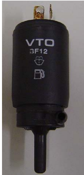
Figura 4.4 - Eletrobomba automotiva (foto do autor).
