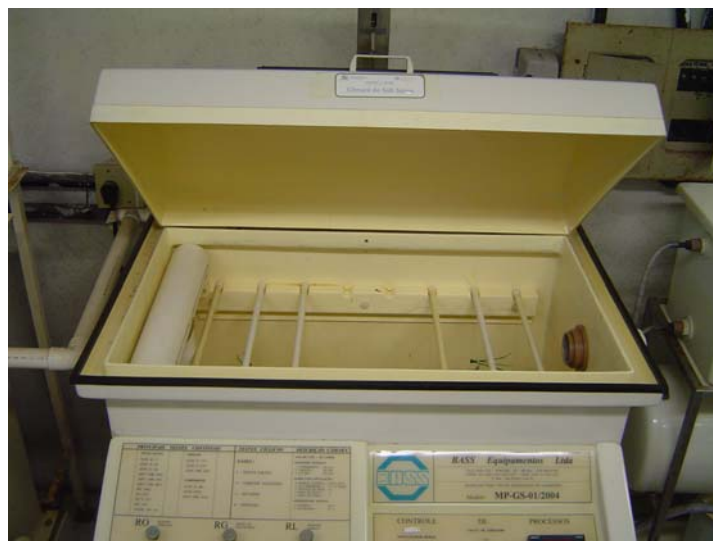
Figura 3.1 - Imagem frontal da câmara de névoa salina (foto do autor).
