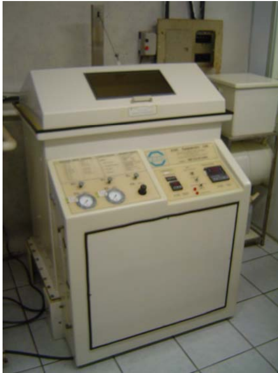
Figura 3.1 - Imagem frontal da câmara de névoa salina (foto do autor).
