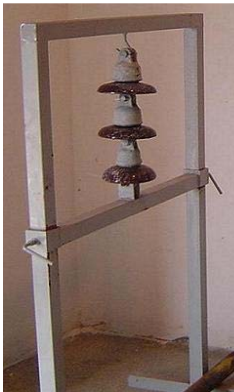
Figura 3.41 - Estrutura para a sustentação das cadeias de isoladores (foto do autor).
