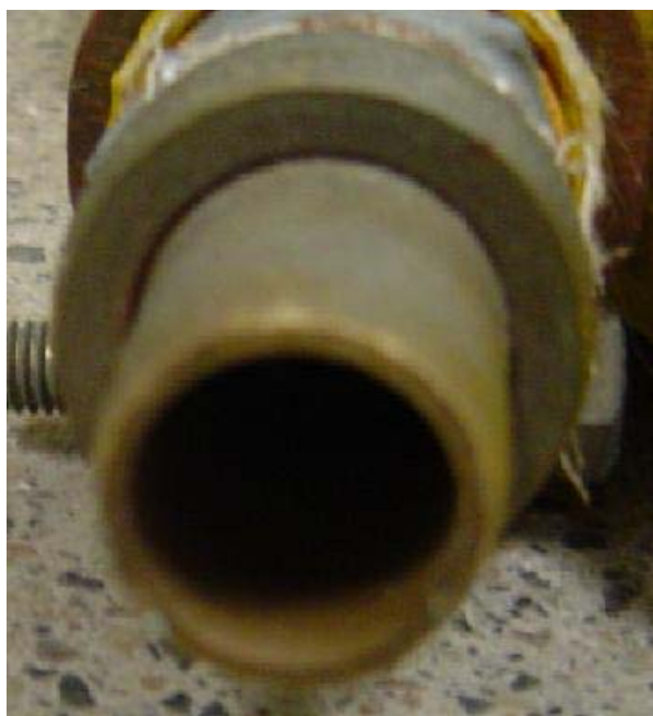
Figura C.5 - Bico utilizado na limpeza (foto do autor).
