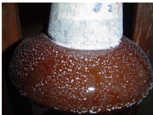
Figura 3.3 - Isolador de porcelana tipo disco (foto do autor).
