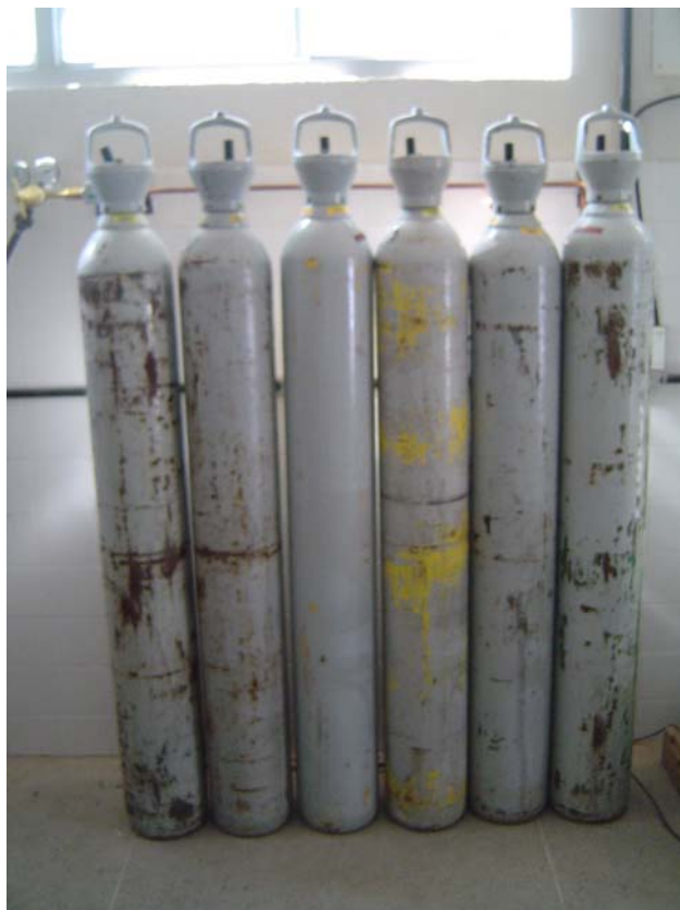
Figura 3.18 - Cilindros de gás nitrogênio para os testes de limpeza das cadeias de isoladores (foto do autor).
