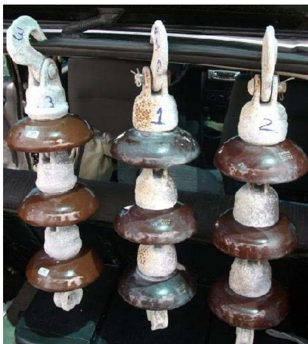
Figura 4.30 - Cadeias de isoladores retiradas de uma linha de distribuição de 13,8 kV para testes (foto do autor).
