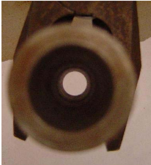
Figura C.3 - Seção cônica de um bico de aço (foto do autor).
