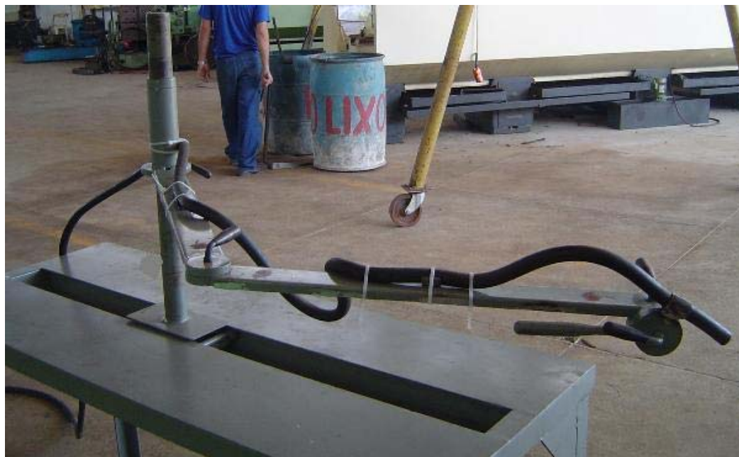
Figura 3.40 - Estrutura mecânica para o teste de limpeza das cadeias de isoladores com a mangueira fixada (foto do autor).
