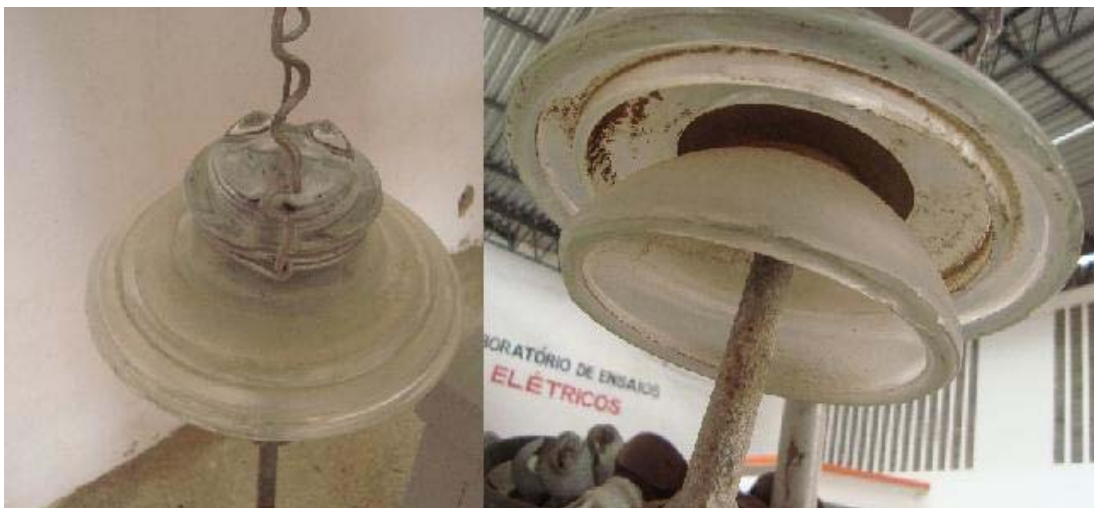
Figura 4.21 - Isolador de pino multicorpo 2 (foto do autor).
