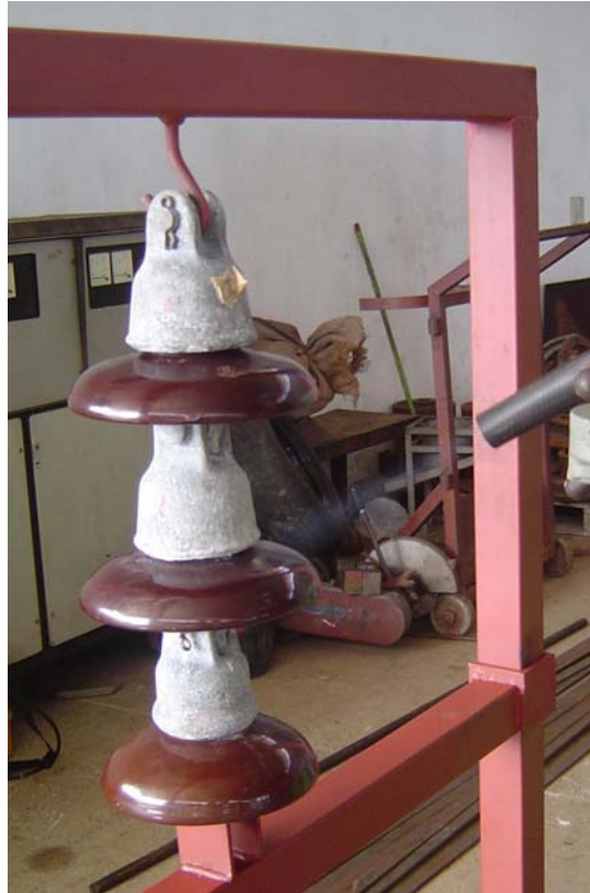
Figura 3.42 – Posicionamento para ataque de ar sobre a superfície do isolador (foto do autor).
