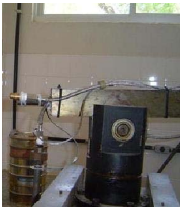
Figura 3.23 - Fixação da serpentina à barra metálica (foto do autor).
