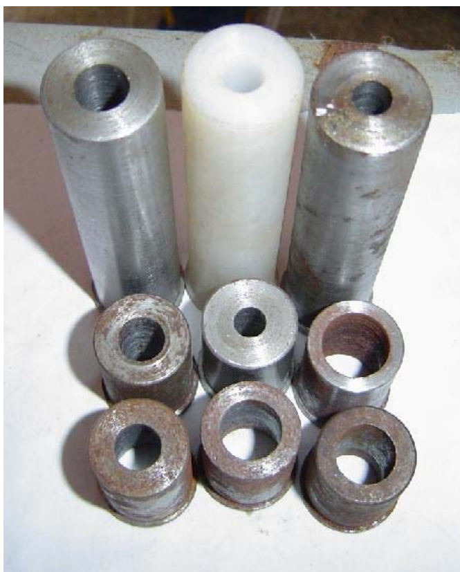
Figura C.1 - Bicos testados no processo de limpeza a seco (foto do autor).
