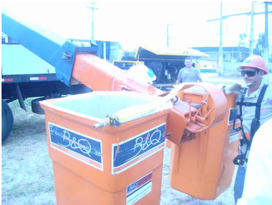
Figura 4.12 - Cesto e controle da lança (foto do autor).
