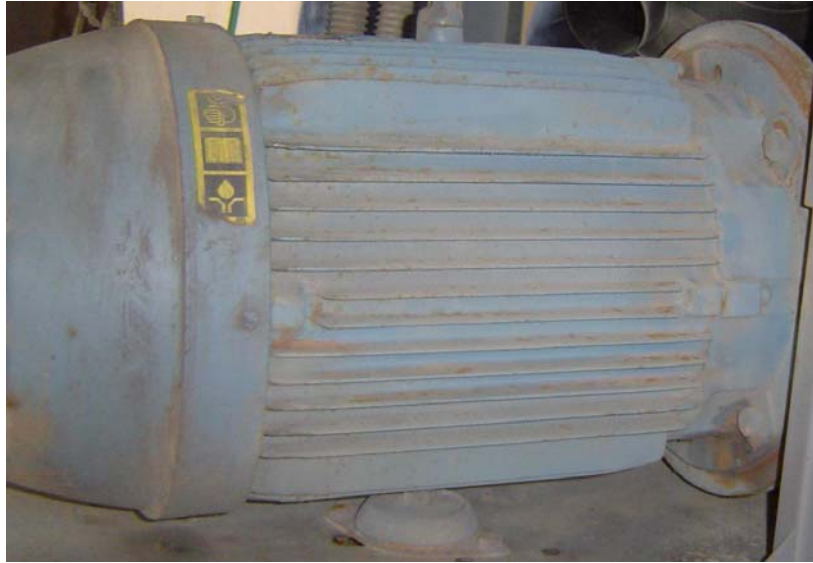
Figura 3.35 - Motor de acionamento do compressor GA 37 (foto do autor).
