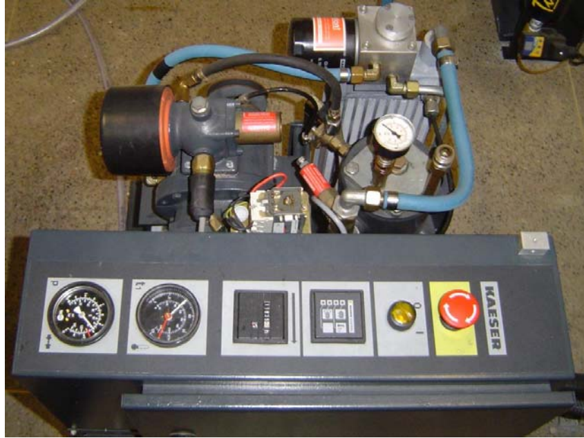
Figura 3.12 - Compressor de parafuso com pressão máxima de trabalho de 7,5 bars e vazão de 339 litros por minuto (foto do autor).
