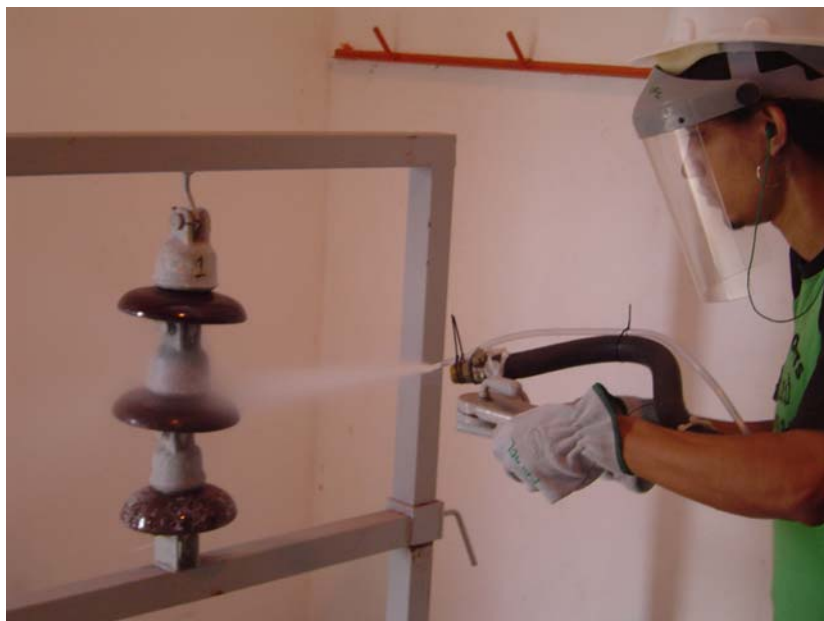
Figura 3.60 - Limpeza da cadeia de isoladores com ar comprimido e uso do procedimento alternativo em laboratório (foto do autor).
