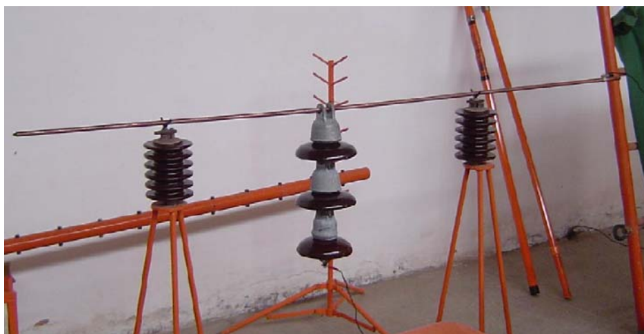
Figura 3.9 - Fixação da cadeia de isoladores para o teste de corrente de fuga (foto do autor).
