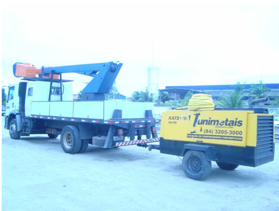
Figura 4.11 - Conjunto caminhão munck e carroceria do compressor acoplados (foto do autor).
