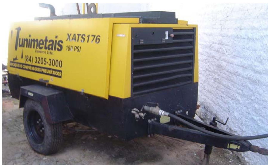
Figura 3.44 - Carroceria que comporta motor e compressor (foto do autor).
