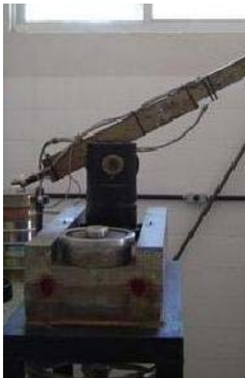
Figura 3.24 - Movimentação vertical da barra de fixação da serpentina flexível (foto do autor).
