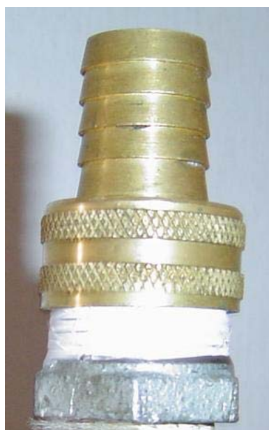
Figura 3.51 - Bico utilizado nos testes de limpeza laboratoriais com o compressor XATS 176 (foto do autor).
