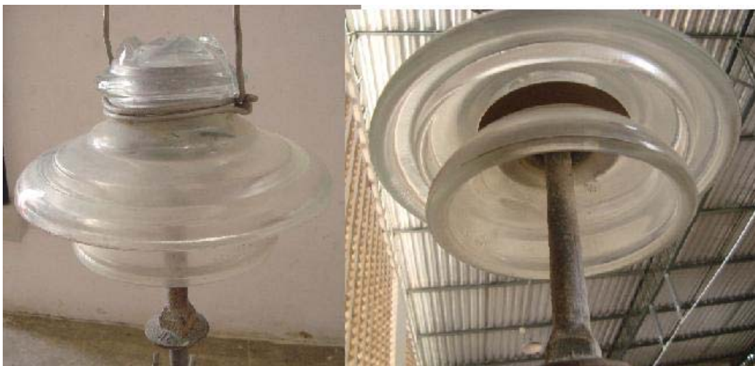
Figura 4.22 - Isolador de pino multicorpo 3 (foto do autor).
