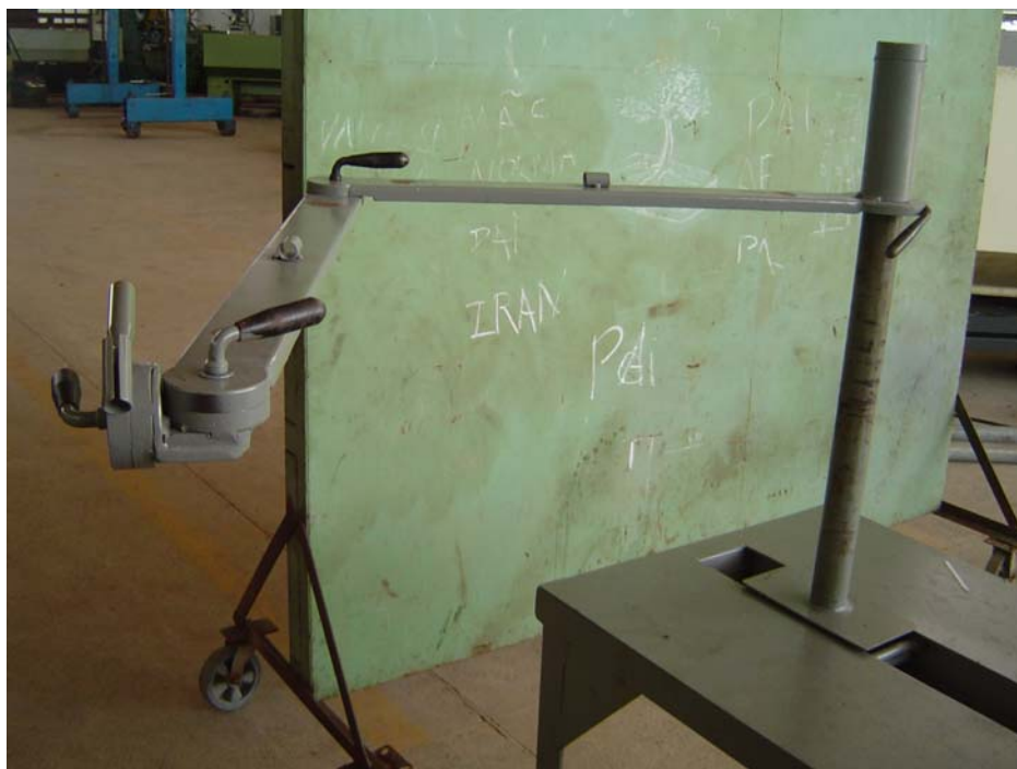
Figura 3.39 - Estrutura mecânica para o teste de limpeza das cadeias de isoladores (foto do autor).
