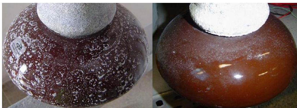
Figura 3.58 - Comparação visual entre um isolador poluído artificialmente e um isolador naturalmente poluído (foto do autor).
