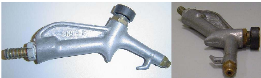
Figura 3.16 - Bico-pistola utilizado para a aplicação do ar sobre o isolador (foto do autor).
