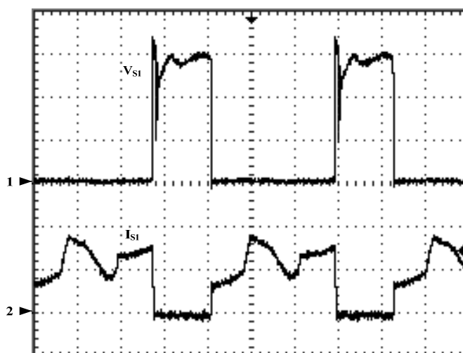
Fig. 5.15 – Formas de onda de tensão e de corrente da chave S_1 , V_{S1} e I_{S1} , experimentais. Escala: 1 - V_{S1} (50V/div.), 2 - I_{S1} (20A/div.), tempo (10µs/div.)
