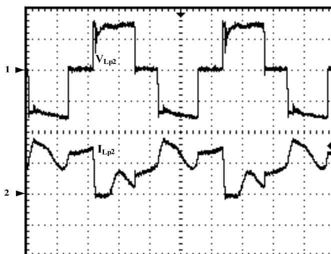
Fig. 5.9 – Formas de onda de tensão e de corrente do enrolamento primário, V_{Lp2} e I_{Lp2} , experimentais. Escala: 1 - V_{Lp2} (50V/div.), 2 - I_{Lp2} (20A/div.), tempo (10 \mu s/div.)
