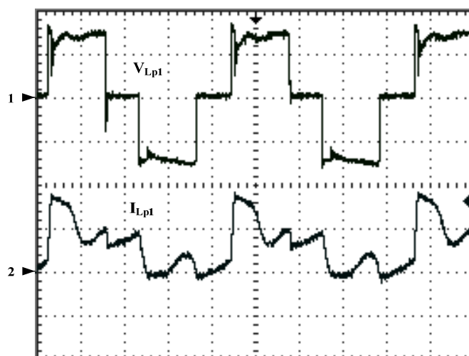
Fig. 5.7 – Formas de onda de tensão e de corrente do enrolamento primário, V_{Lp1} e I_{Lp1} , experimentais. Escala: 1 - V_{Lp1} (50V/div.), 2 - I_{Lp1} (20A/div.), tempo (10 \mu s/div.)
