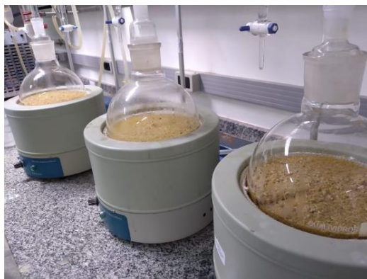
Figura 6 – Processo de hidrodestilação usando aparelho de Clevenger
