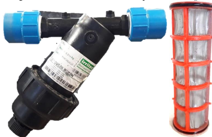
Figura 22 - Filtro de tela 120 mesh para retrolavagem
