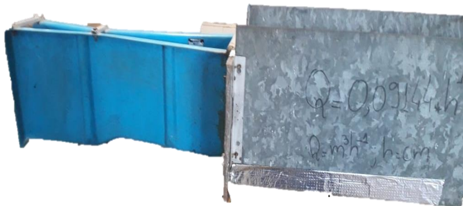
Figura 17 - Medidor de vazão tipo parshall
