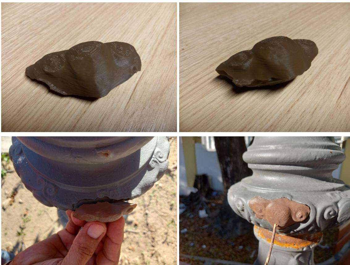
Figura 33: protótipos impressos por FFF e seus respectivos testes de encaixe. poste 1 à esquerda e poste 2 à direita. Fonte: Acervo do autor.
