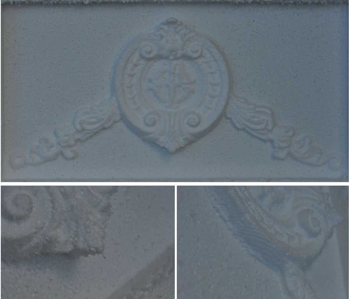
**Figura 39:** protótipo usinado em isopor. Fonte; Acervo do autor.
