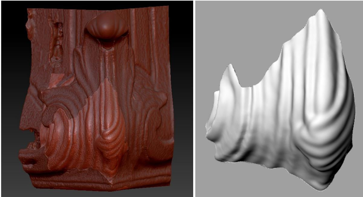
**Figura 27:** Ambos os modelos da peça deteriorada e a peça de referência sobrepostos (esquerda). fragmento gerado após a operação booleana. Fonte: Acervo do autor.
