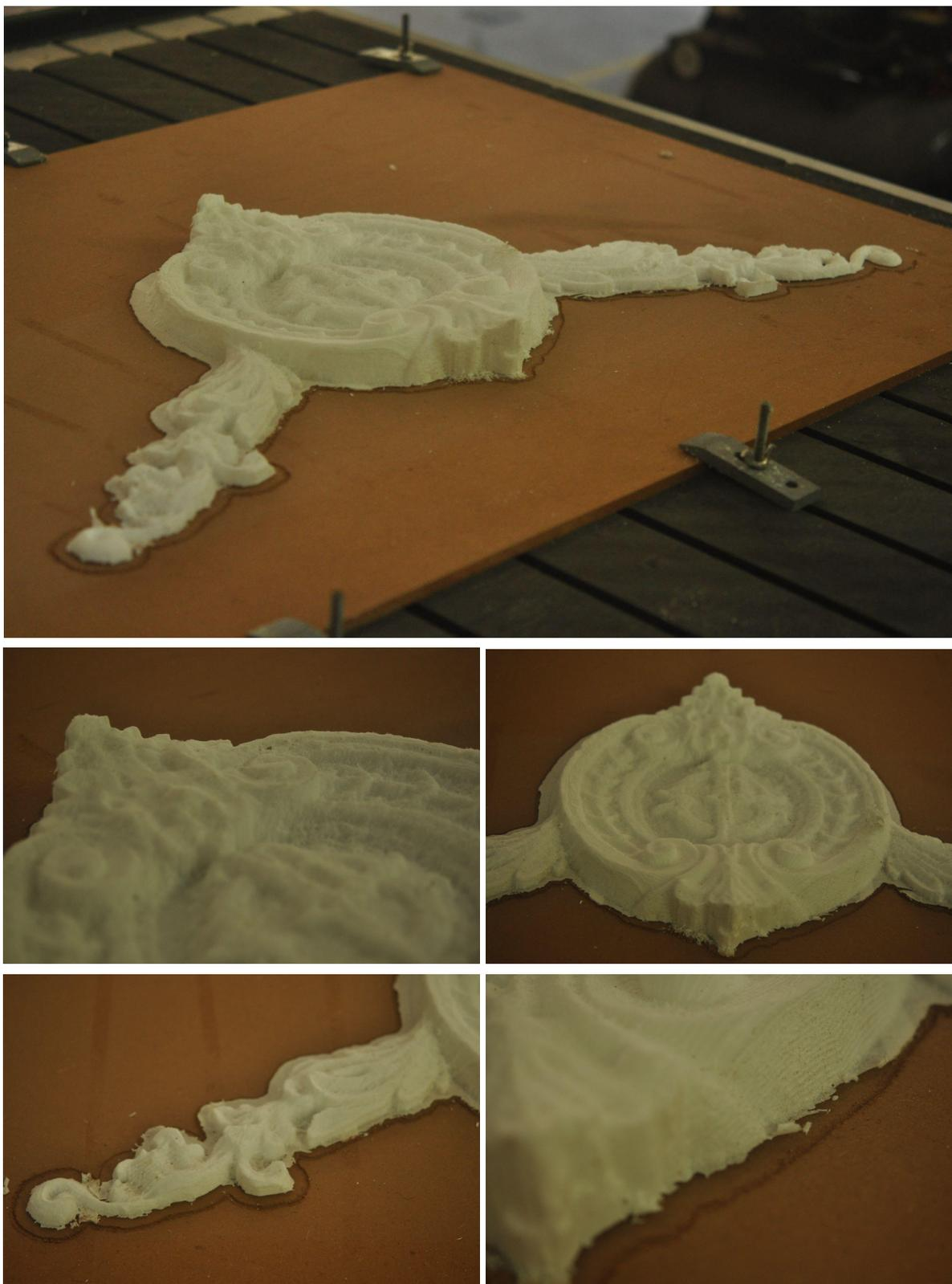
Figura 40: protótipo usinado em XPS (poliestireno extrudado). Fonte: Acervo do autor.
