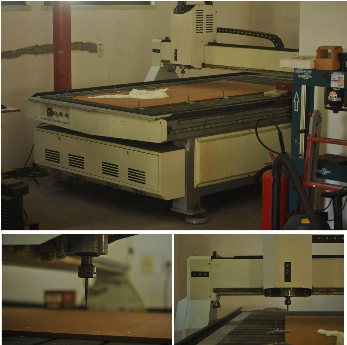
Figura 9: Fresadora modelo Duplotech CNC Router 1325, utilizada na produção dos modelos usinados deste trabalho. Fonte: Acervo do autor.
